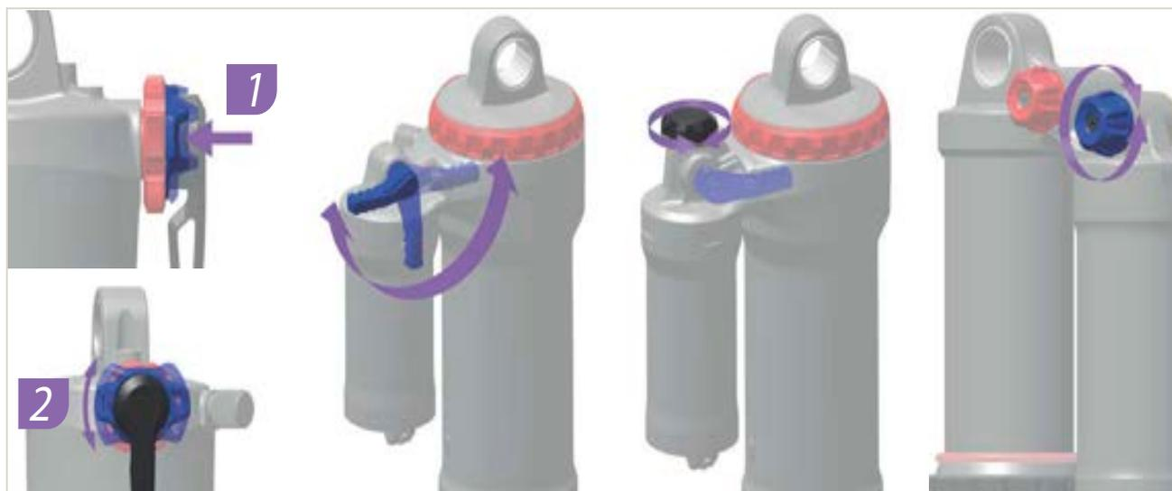
Illustration 173 : La position et la forme du dispositif de réglage de la compression (bleu) dépendent du modèle
