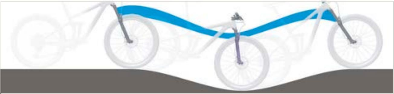
Illustration 236 : Suspension trop souple de la fourche suspendue dans les côtes
