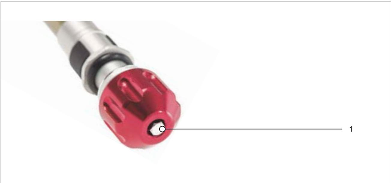
Illustration 243 : Exemple d'un réglage de détente SR SUNTOUR (fourche) (1)
