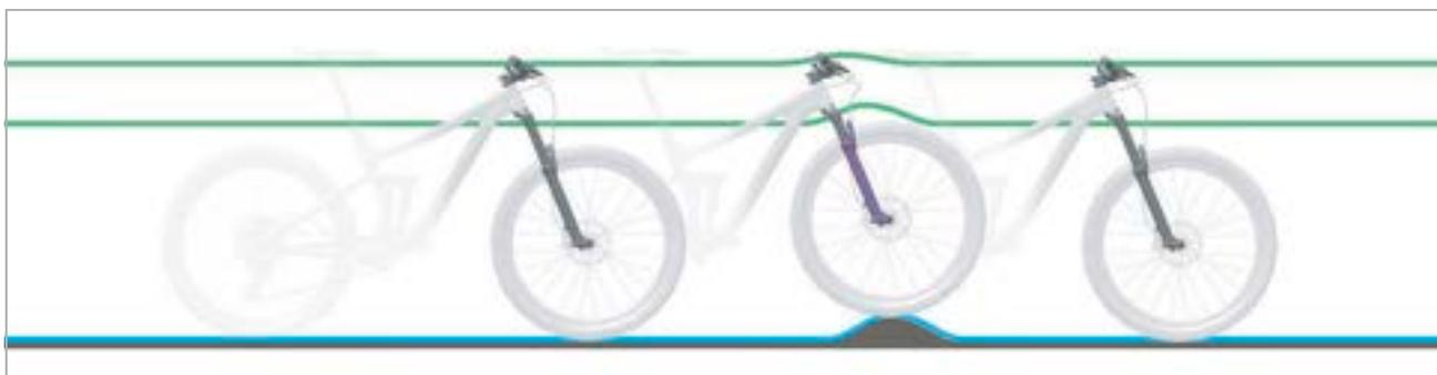
Illustration 168 : Amortisseur de compression avec réglage dur et souple
