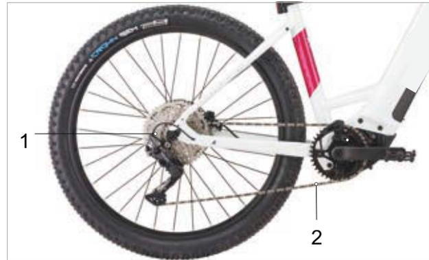
Illustration 45 : Schéma de l'entraînement à chaîne avec dérailleur
