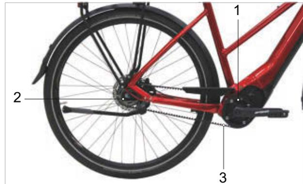
Illustration 46 : Schéma de l'entraînement à courroie
