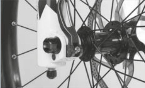
Illustration 228 : Régler la force de serrage de l'attache rapide
