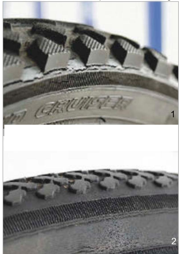
Illustration 199 : Exemples de fissures de fatigue (1) et de fissures d'âge (2)
