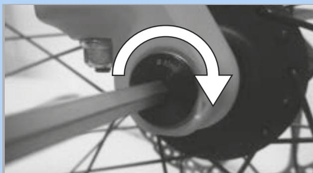
Illustration 75 : Serrer l'axe dans le sens de la flèche
