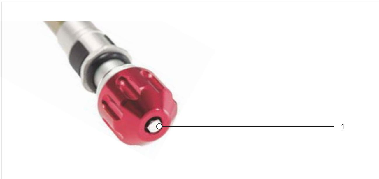
Illustration 241 : Exemple d'un réglage de détente SR SUNTOUR (fourche) (1)
