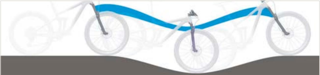
Illustration 250 : Suspension trop souple de la fourche suspendue dans les côtes
