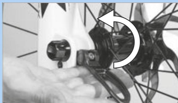
Illustration 81 : Enfoncez le levier d'attache rapide dans le sens de la flèche
