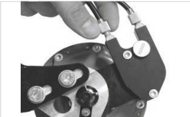
Illustration 225 : Sur les versions de moyeux ROHLOFF avec commande externe du changement de vitesse, le dispositif de réglage de la tension est situé sur le boîtier de câbles qui est placé sur le côté gauche.
