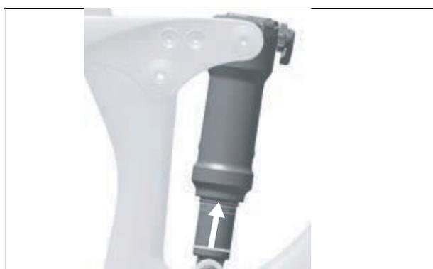
Illustration 144 : Déplacer le joint torique sur l'amortisseur arrière
