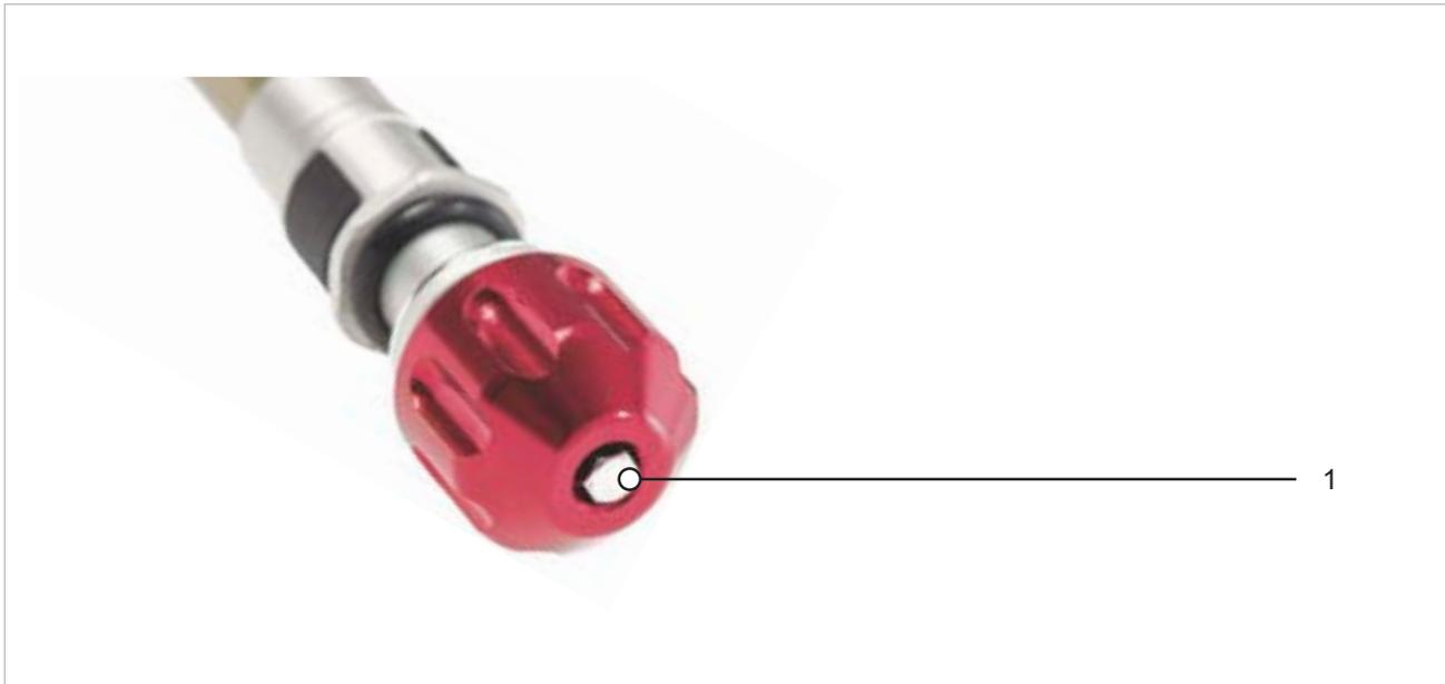
Illustration 148 : Exemple d'un réglage de détente SR SUNTOUR (fourche) (1)
