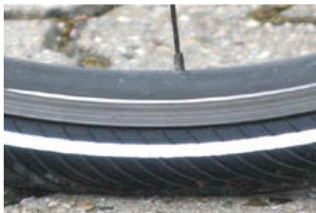
**Illustration 119 : Pression correcte. Le pneu se déforme à peine sous le poids du corps.**
