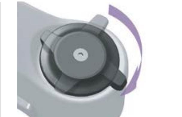
Illustration 237 : Régler le dispositif de réglage de la compression sur un niveau plus dur
