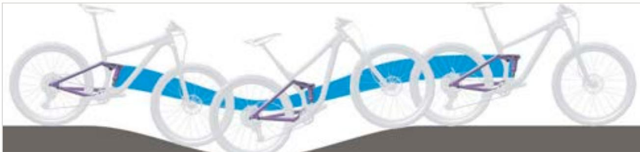
Illustration 268 : Suspension trop souple de l'amortisseur arrière dans les côtes
