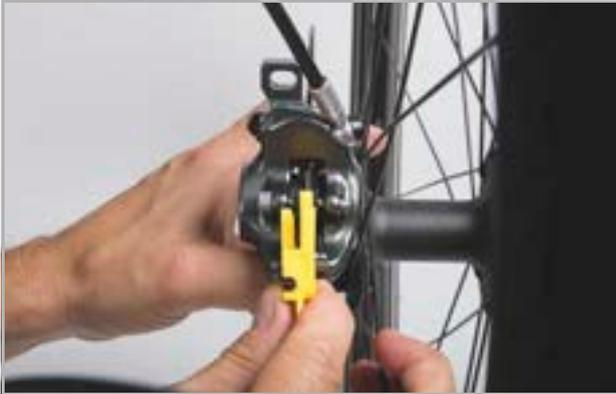
Illustration 200 : Contrôler la plaquette de frein montée à l'aide de la cale de transport
