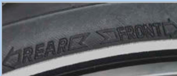
Illustration 72 : Flèche directionnelle sur les pneus VTT
