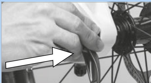
Illustration 85 : Enfoncez l'attache rapide dans le sens de la flèche
