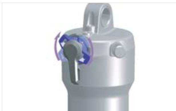
Illustration 175 : Régler le dispositif de réglage de la compression sur un niveau plus dur
