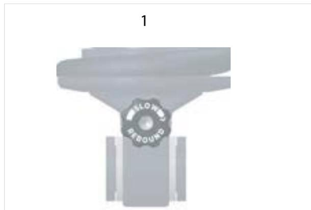
Illustration 155 : Dispositif de réglage de la détente du Float DHX (1)
