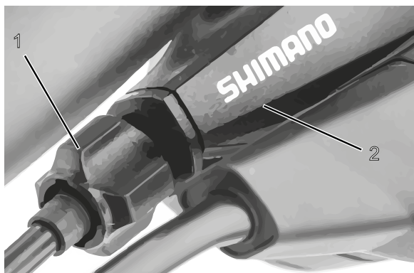
Afbeelding 54: Afstelwartel (1) van de versnelling met enkele bowdenkabelbediening en behuizing van de schakelhendel (2), voorbeeld
