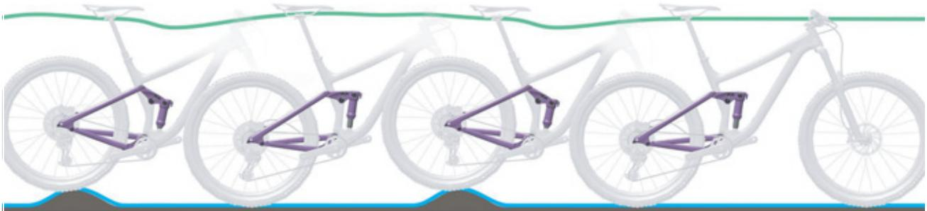
Figura 100: Condición óptima de marcha del amortiguador de la horquilla trasera
