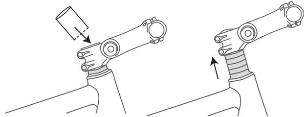
Figura 83: Aumento de la potencia Ahead mediante el montaje de anillos distanciadores (separadores)
