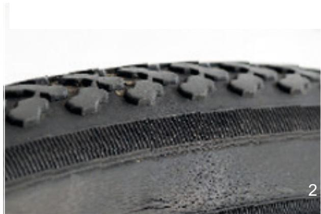
Figura 135: Ejemplos de fisuras por fatiga (1) y fisuras por envejecimiento (2)
