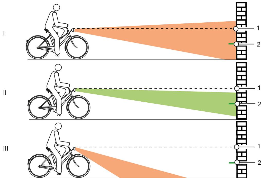
Figura 106: Luz ajustada demasiado alta (1), correctamente (2) y demasiado baja (3)
