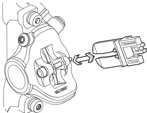
Figura 46: Fijación del seguro de transporte
