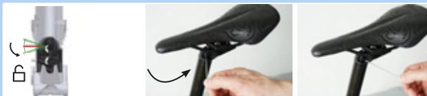
Figura 147: Colocar el accionamiento del ajuste de altura en la "Posición abierta"
