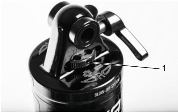
Figura 101: Rueda del regulador de niveles de tracción Suntour (1) en el amortiguador de la horquilla trasera
