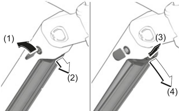
Figura 118: Extracción de la batería integrada
