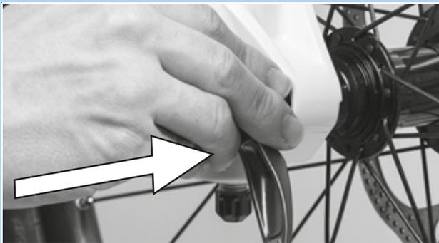
Figura 63: Inserción del cierre rápido en la dirección de la flecha
