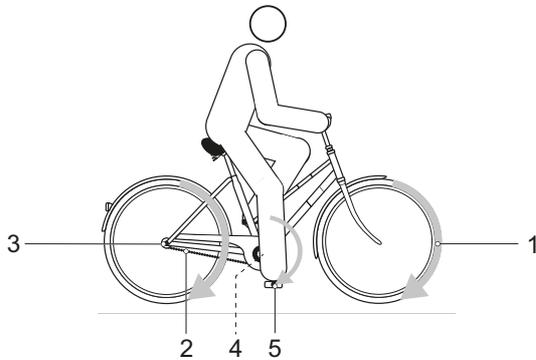
Figura 31: Esquema del sistema de accionamiento mecánico
