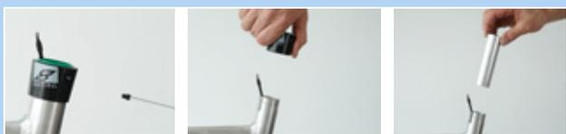
Figura 155: Desmontaje del manguito exterior y del casquillo deslizante
