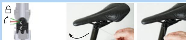
Figura 184: Cierre del ajuste de altura
