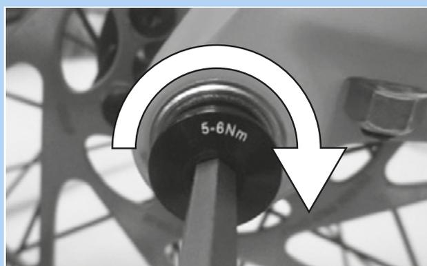
Figura 55: Apriete del tornillo de seguridad
