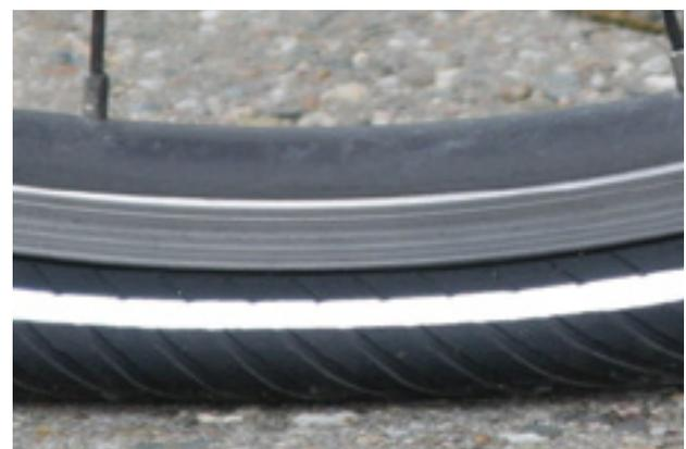
Figura 94: Presión de inflado demasiado baja
