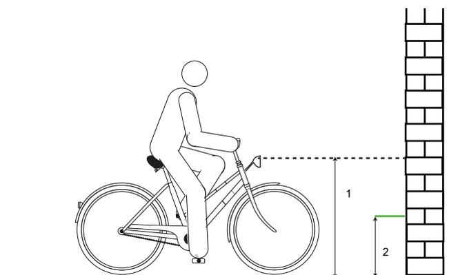
Figura 105: Altura de la luz delantera (1) y la mitad de la altura de la luz delantera (2)
