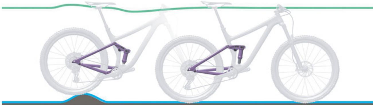
Figura 102: Condición óptima de marcha del amortiguador de la horquilla trasera en caso de irregularidades
