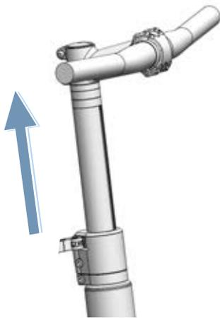
Figura 128: Ejemplo de All Up estirado hasta la posición más alta
