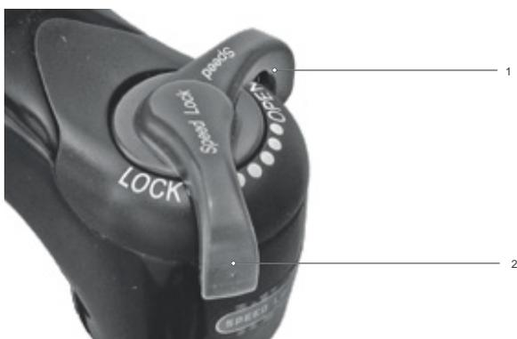
Figura 216: Ajuste para un regulador de niveles de presión más blando
