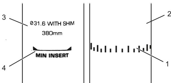
Figura 74: Vista detallada de las tijas de sillín, ejemplos de las marcas de la profundidad de inserción mínima
