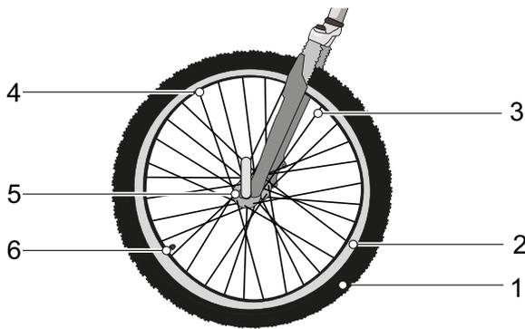
Figura 21: Componentes visibles de la rueda
