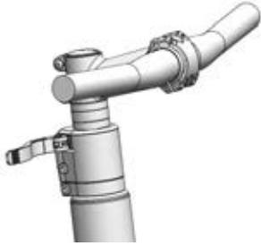
Figura 127: Ejemplo de All Up con palanca tensora de la potencia abierta
