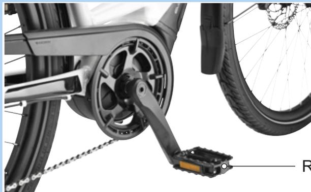
Figura 68: Pedal R en el brazo de manivela derecho
