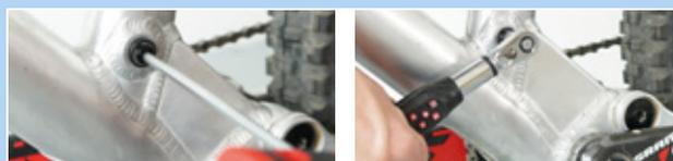
Figura 177: Fijación del eje Postpin
