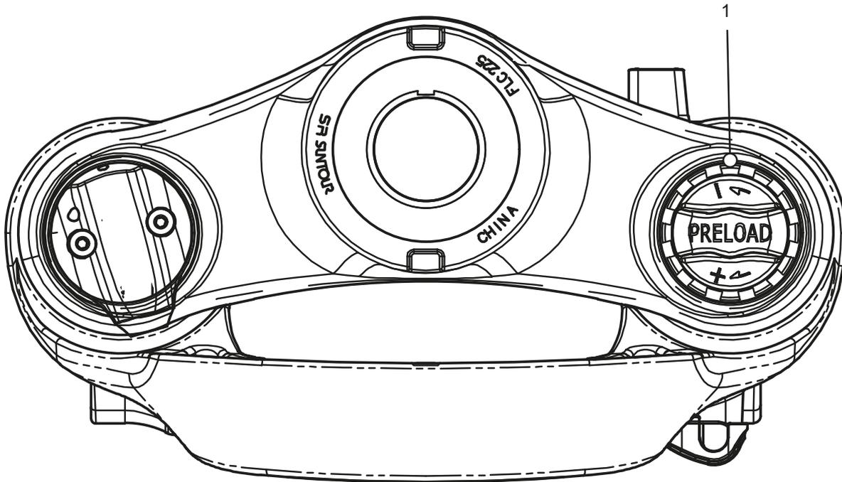
Figura 96: Rueda de ajuste SAG (1) en la corona de la horquilla de suspensión
