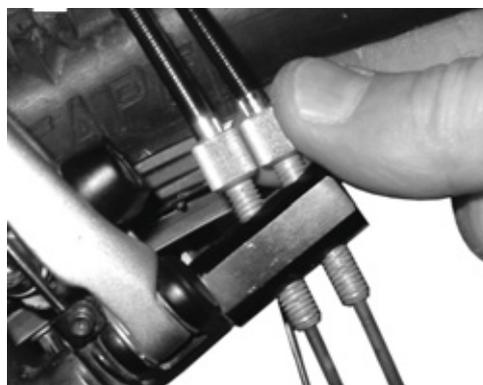
Figura 139: Las versiones de bujes Rohloff con activación de cambio interna tienen los dispositivos de ajuste de tensión en el contraapoyo de tensión
