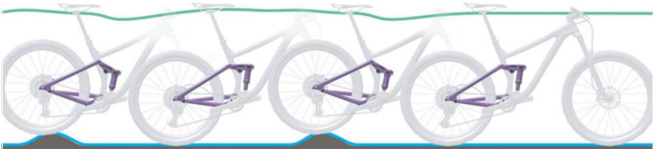
Figura 19: Condición óptima de marcha del amortiguador de la horquilla trasera
