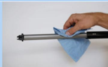
Figura 200: Limpieza de la ranura de guía longitudinal
