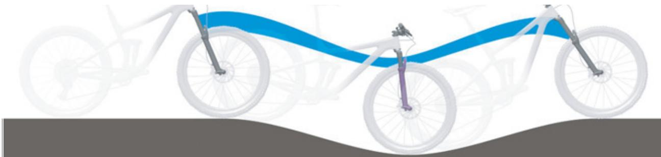
Figura 213: Suspensión de la horquilla de suspensión demasiado blanda en montaña
