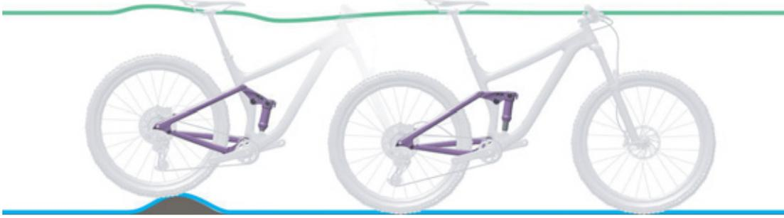
Figura 17: Condición óptima de marcha del amortiguador de la horquilla trasera en caso de irregularidades
