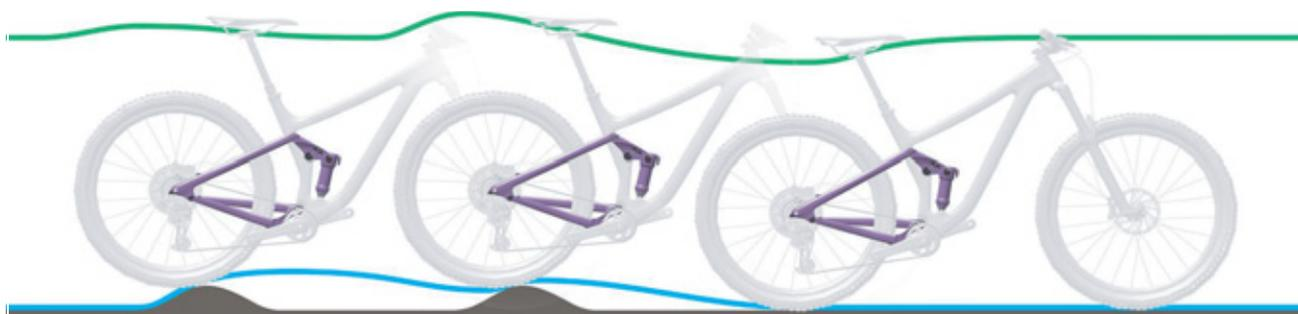
Figura 219: Descompresión demasiado lenta del amortiguador de la horquilla trasera
