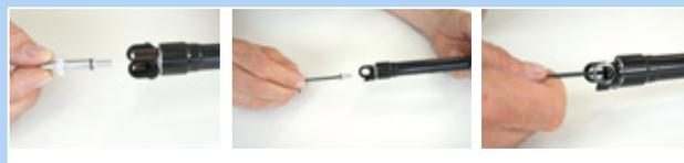
Figura 170: Fijación la tapa de la válvula del cartucho
