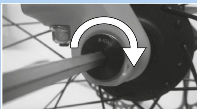
Figura 53: Apriete del eje en la dirección de la flecha
