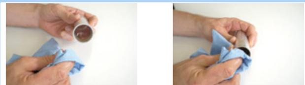
Figura 162: Limpieza del tubo del casquillo deslizante
