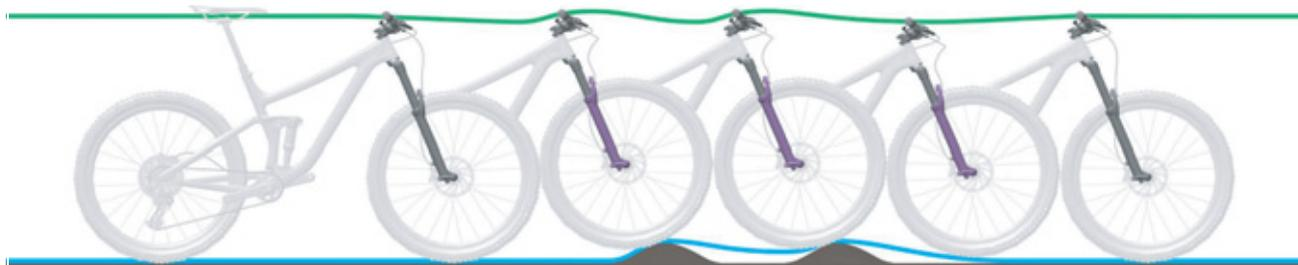
Figura 211: Descompresión demasiado lenta de la horquilla de suspensión
