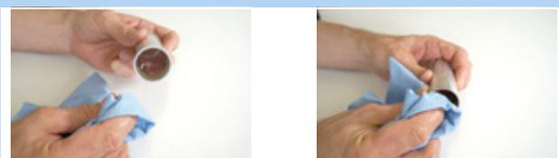
Figura 197: Limpieza del tubo del casquillo deslizante
