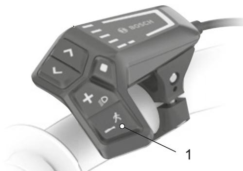
Figura 124: Posición del botón de ayuda para el desplazamiento (1)
