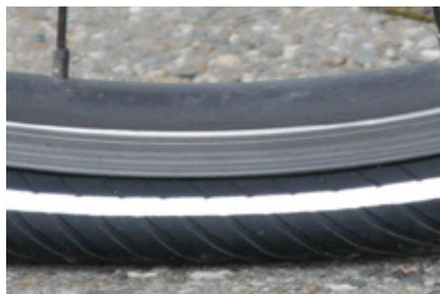
Figura 88: Presión de inflado demasiado baja
