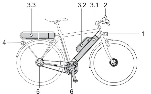
Figura 34: Esquema del sistema de accionamiento eléctrico con componentes eléctricos
