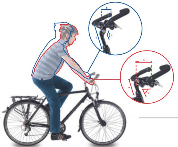
Figura 85: Posición de la bicicleta de ciudad (azul) y la bicicleta de trekking (rojo) mediante la modificación angular
