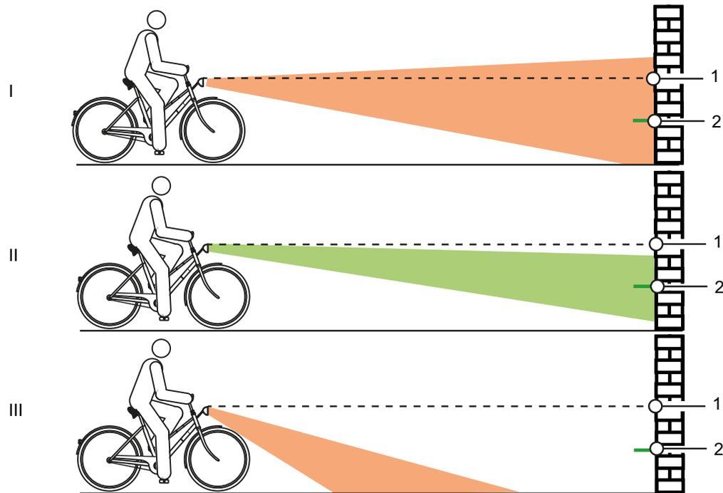
Figura 137: Luz ajustada demasiado alta (1), correctamente (2) y demasiado baja (3)
