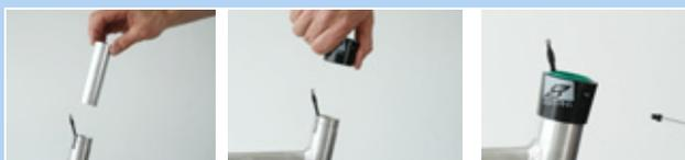
Figura 204: Montaje del casquillo deslizante y del manguito exterior
