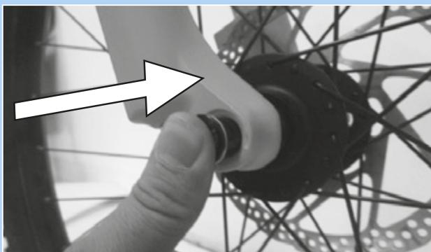
Figura 52: Inserción del eje en la dirección de la flecha
