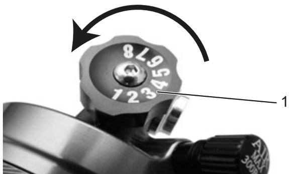
Figura 224: Regulador de niveles de presión Suntour (1) en el amortiguador de la horquilla trasera
