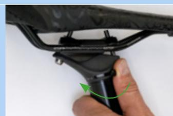
Figura 203: Cierre del ajuste de altura
