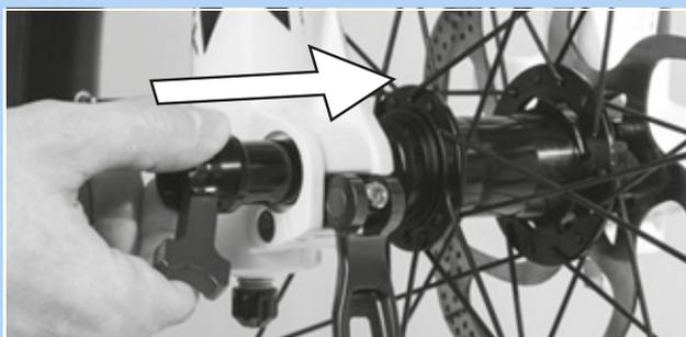
Figura 56: Inserción del eje transversal en la dirección de la flecha
