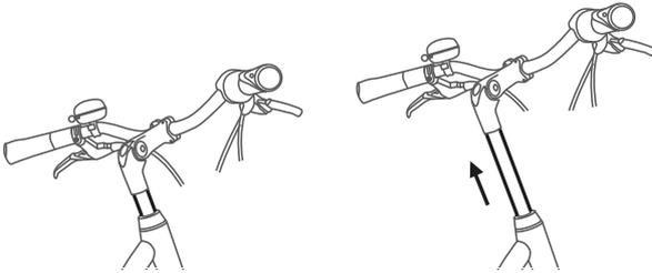
Figura 82: Ajuste de la altura de la potencia de vástago
