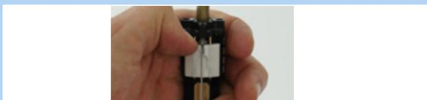
Figura 173: Desplazamiento hacia abajo de la guía deslizante de accionamiento blanca
