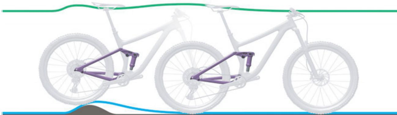
Figura 223: Amortiguación del amortiguador de la horquilla trasera demasiado dura en caso de irregularidades
