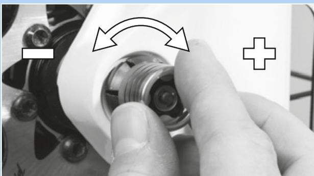
Figura 64: Ajuste de la tensión
