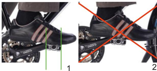
Figura 117: Posición correcta (1) e incorrecta (2) del pie sobre el pedal
