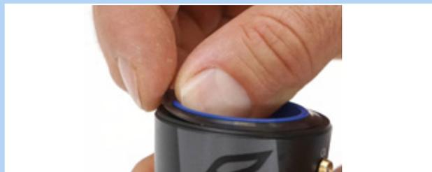
Figura 190: Retirada del anillo con falda de obturación
