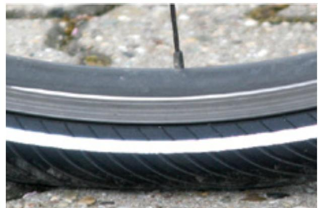
Figura 93: Presión de inflado correcta. La cubierta apenas está deformada bajo la carga del peso corporal
