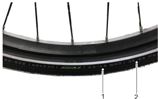
Figura 133: Presión de inflado en bar (1) y psi (2)
