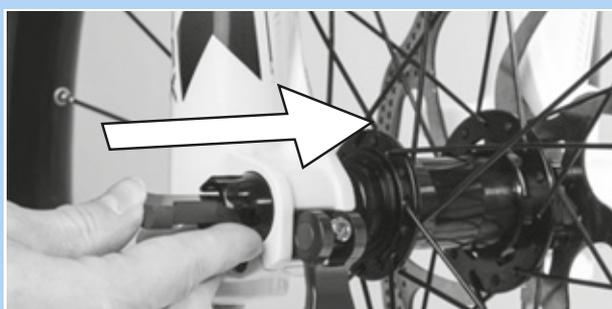
Figura 58: Inserción de la palanca roja en la dirección de la flecha
