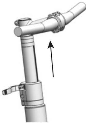
Figura 81: Movimiento hacia arriba de la palanca de seguridad, ejemplo All Up
