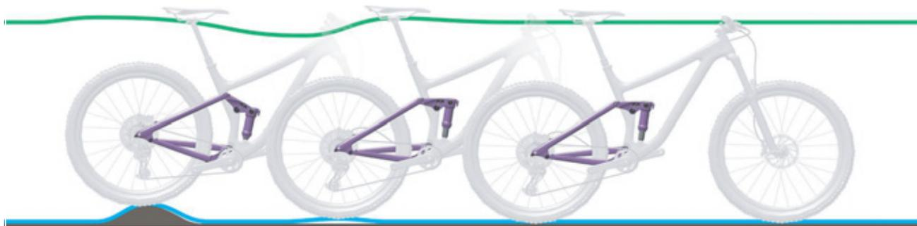
Figura 217: Descompresión demasiado rápida del amortiguador de la horquilla trasera
