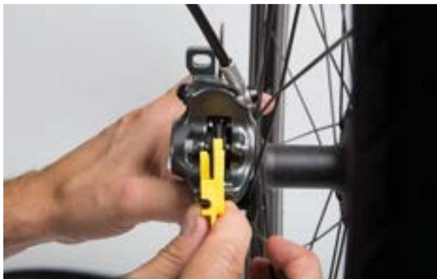
Figura 136: Comprobación de la almohadilla de freno montada con ayuda del seguro de transporte
