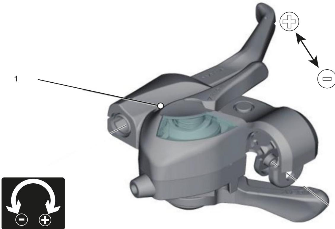
Figura 95: Posición del tornillo de ajuste (1)
