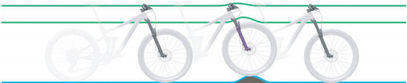
Figura 10: Condición óptima de marcha de la horquilla en caso de irregularidades
