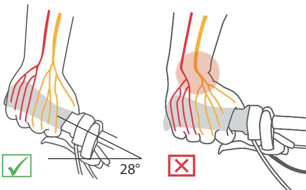
Figura 79: Disposición de los nervios con el manillar doblado y recto
