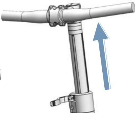
Figura 114: Ejemplo de All Up estirado hasta la posición más alta
