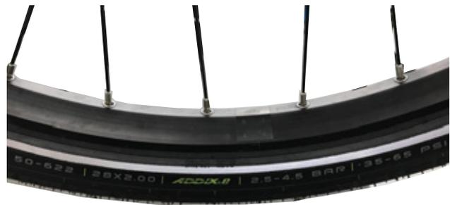
Figura 22: Ejemplo: Información en la cubierta
