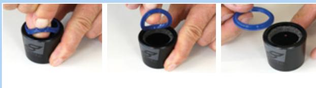
Figura 192: Extracción del rascador
