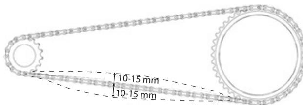
Figura 138: Comprobación de la tensión de la cadena
