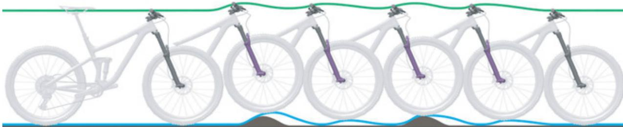
Figura 209: Descompresión demasiado rápida de la horquilla de suspensión
