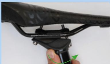
Figura 198: Apertura del ajuste de altura
