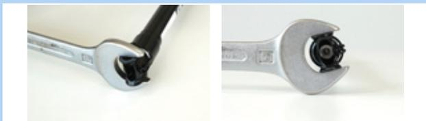
Figura 168: Aseguramiento para evitar el giro
