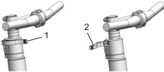
Figura 80: Palanca tensora de la potencia cerrada (1) y abierta (2), ejemplo All Up
