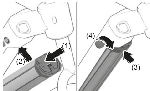
Figura 119: Inserción de la batería integrada
