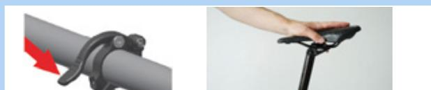
Figura 183: Ajuste de la altura de la tija de sillín
