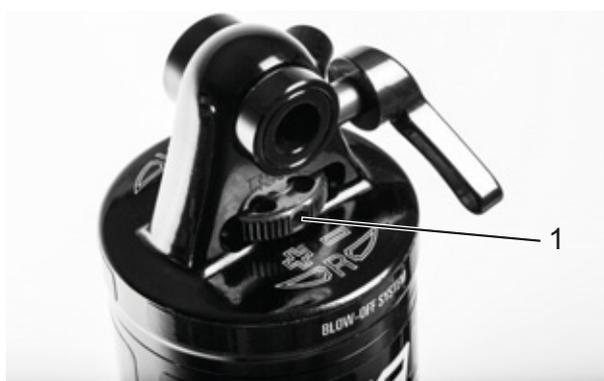
Figura 220: Rueda del regulador de niveles de tracción Suntour (1) en el amortiguador de la horquilla trasera
