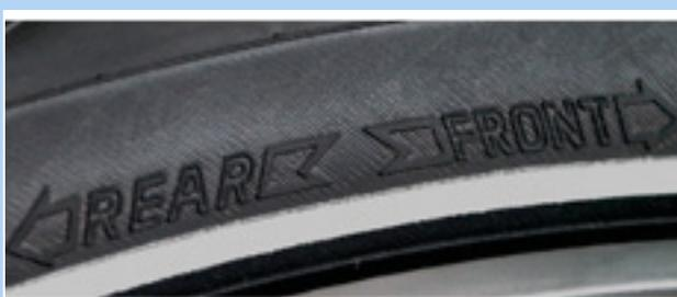
Figura 51: Flecha de sentido de la marcha en cubiertas de MTB
