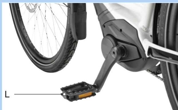
Figura 67: Pedal L en el brazo de manivela izquierdo
