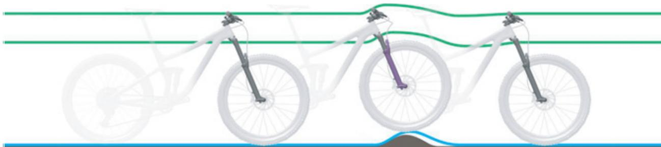
Figura 215: Amortiguación de la horquilla de suspensión demasiado dura en caso de irregularidades
