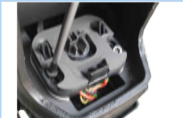
Figura 47: Aflojamiento de los tornillos del soporte de la batería
