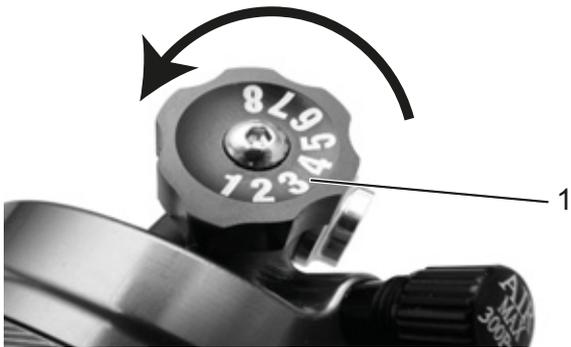
Figura 103: Regulador de niveles de presión Suntour (1) en el amortiguador de la horquilla trasera
