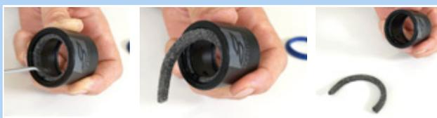
Figura 193: Retirada del anillo de fieltro
