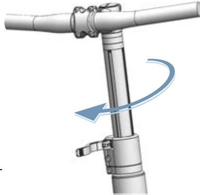
Figura 129: Ejemplo de All Up enroscado
