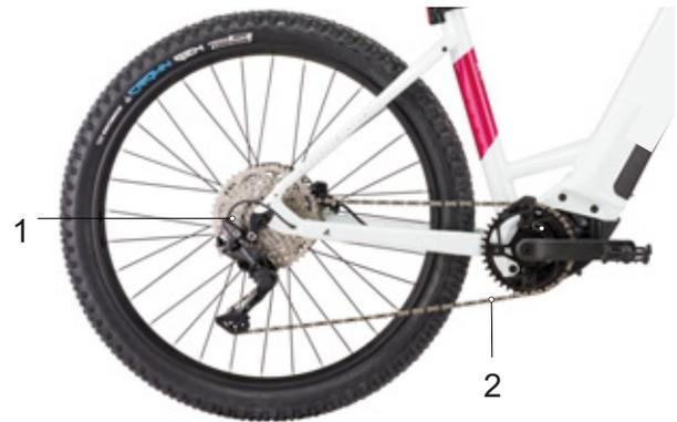
Figura 32: Esquema de la transmisión por cadena con cambio de cadena
