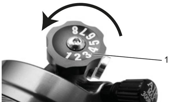
Figura 222: Regulador de niveles de presión Suntour (1) en el amortiguador de la horquilla trasera
