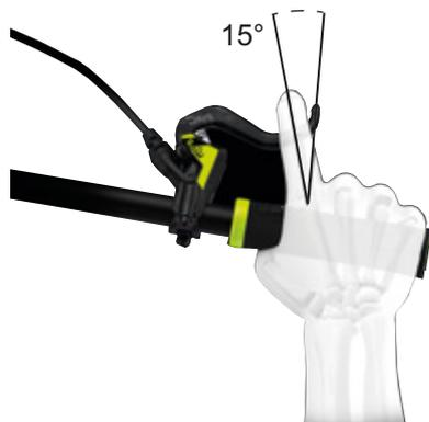
Figura 89: Posición de la palanca de freno
