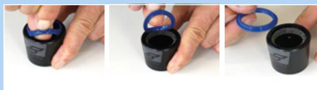
Figura 157: Extracción del rascador
