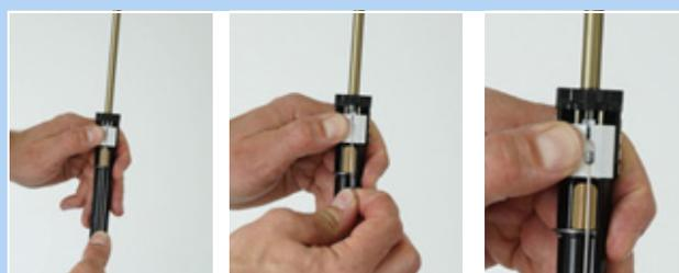
Figura 152: Desenganchar el cable de accionamiento
