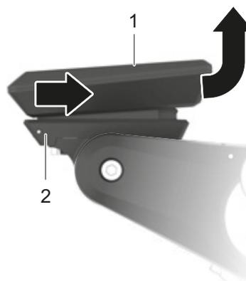
Figura 109: Retirada del ordenador de a bordo
