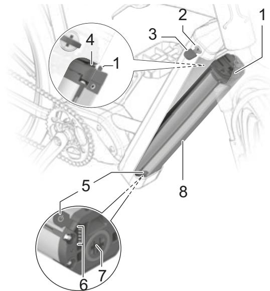
Figura 36: Detalle de la PowerTube 750
