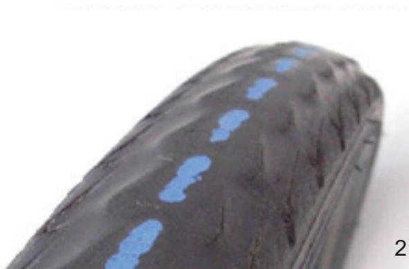
Figura 134: Cubierta sin perfil que aún puede utilizarse (1); cubierta con protección contra pinchazos visible que tiene que cambiarse (2)
