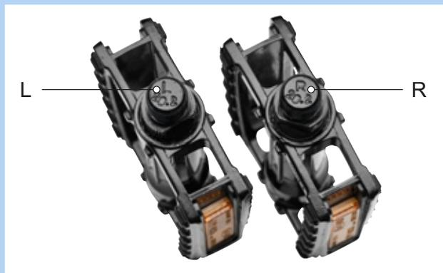
Figura 66: Ejemplo de identificación de los pedales
