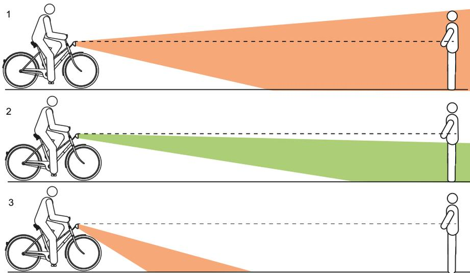
Figura 104: Luz ajustada demasiado alta (1), correctamente (2) y demasiado baja (3)
