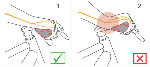
Figura 86: Posición correcta (1) e incorrecta (2) del puño
