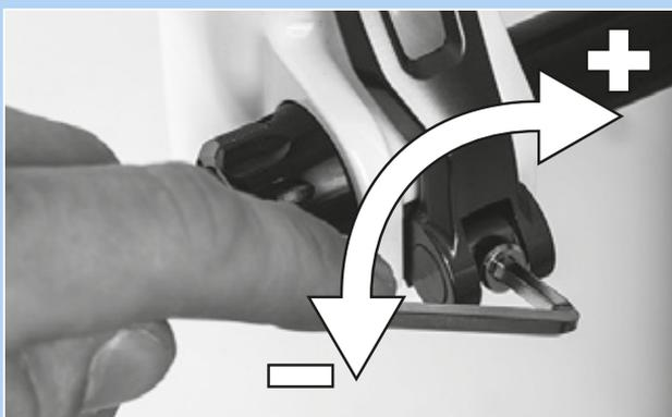
Figura 61: Ajuste de la fuerza de tensado del cierre rápido
