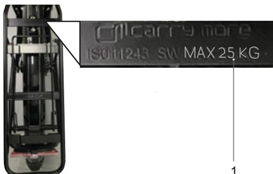
Figura 116: Identificar la capacidad máxima de carga (1) sobre el portaequipajes
