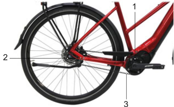
Figura 33: Esquema de la transmisión por correa
