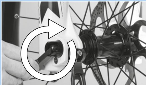
Figura 57: Apriete del eje en la dirección de la flecha
