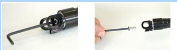
Figura 167: Desenroscar la tapa de la válvula
