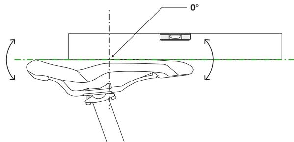
Figura 77: Inclinación del sillín horizontal con 0° de inclinación en el centro del sillín
