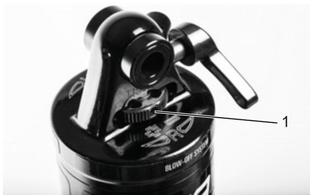
Figura 218: Rueda del regulador de niveles de tracción Suntour (1) en el amortiguador de la horquilla trasera
