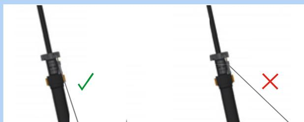
Figura 153: Posición del cable de accionamiento
