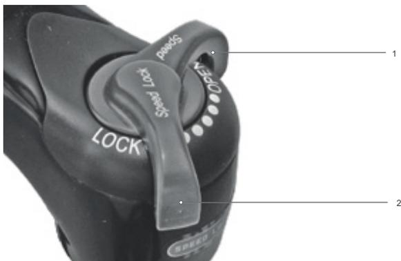
Figura 214: Ajuste para un regulador de niveles de presión más duro
