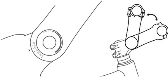
Figura 84: Diferentes versiones de potencias con ajuste angular
