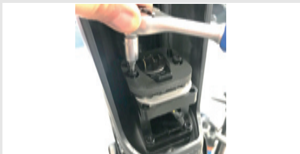
Illustration 22 : Desserrer les vis du logement de batterie
