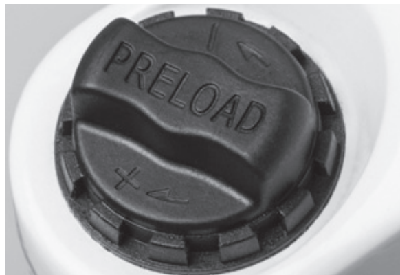
Illustration 55 : Molette de réglage de la course de suspension négative sur la couronne de la fourche de suspension
