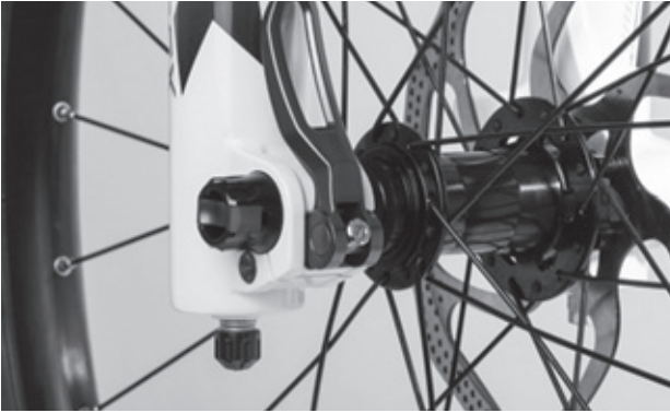
Illustration 67 : Régler la force de serrage de l'attache rapide
