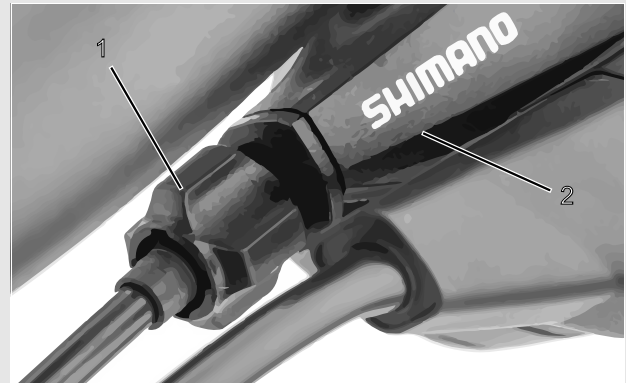
Illustration 69 : Douille de réglage (1) du changement de vitesse à un câble actionné par câble avec boîtier de manette de vitesse (2), exemple
