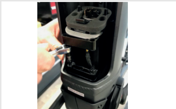
Illustration 23 : Retirer les vis à 6 pans de 4 mm
