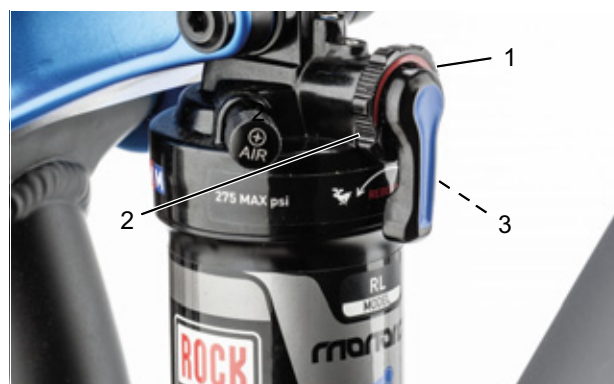
Illustration 79 : Régler la dureté de l'amortisseur de détente (1) de l'amortisseur arrière
