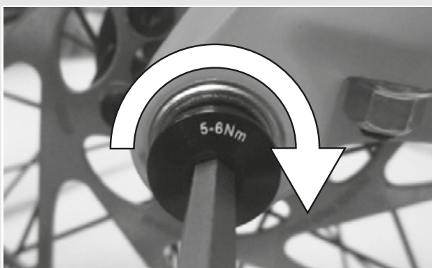
Illustration 28 : Serrer la vis de blocage
