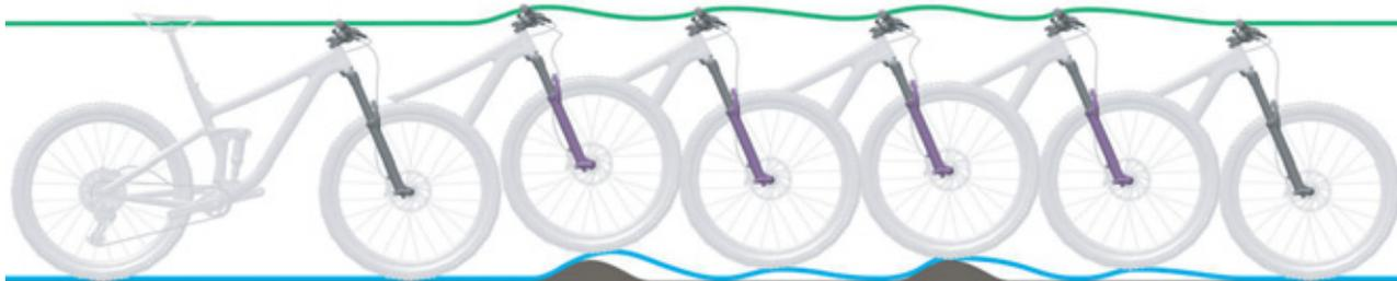
Figura 218: Corsa di estensione troppo veloce della forcella ammortizzata
