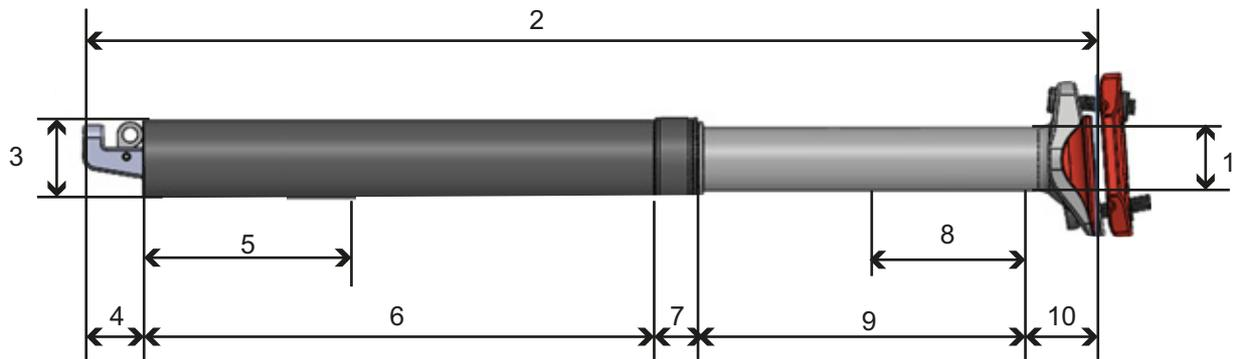
Figura 62: Dimensioni cannotto reggisella LIMOTEC, A3/A3 Plus
