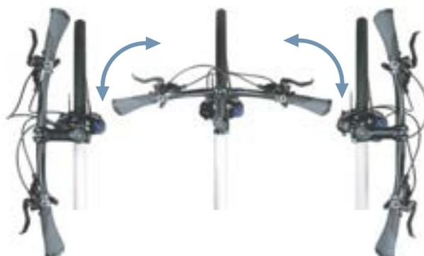
Figura 10: Funzione Twist, esempio BY.SCHULZ
