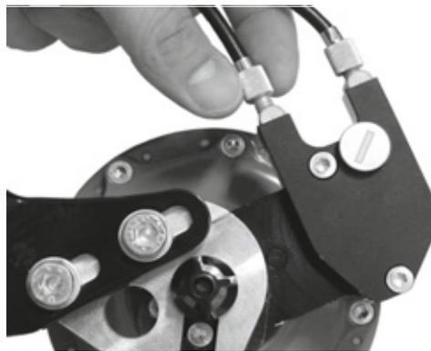
Figura 211: Le versioni del mozzo ROHLOFF con comando esterno del cambio hanno i regolatori del tensionamento sulla scatola dei cavi situata sul lato sinistro
