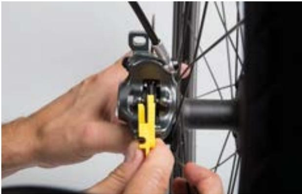
Figura 186: Controllo della guarnizione del freno nello stato montato mediante la sicura di trasporto
