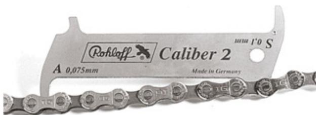
Figura 191: Esempio di calibro di misura dell'usura ROHLOFF
