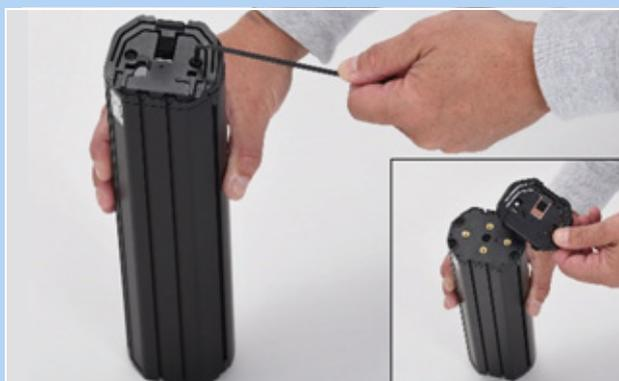
Figura 75: Smontaggio dell'interfaccia superiore
