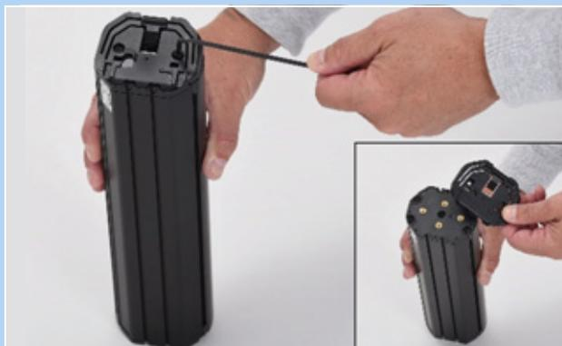
Figura 72: Smontaggio dell'interfaccia superiore
