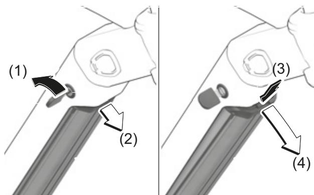
Figura 166: Smontaggio della batteria integrata
