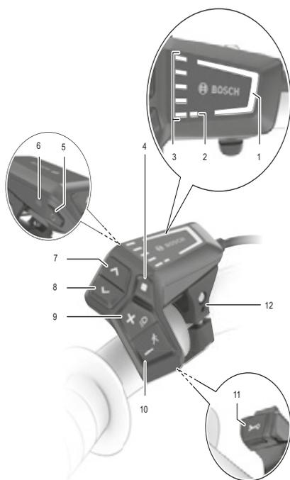
Figura 169: Schema del computer di bordo BOSCH LED Remote
