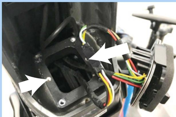
Figura 71: Serraggio delle viti del portabatteria
