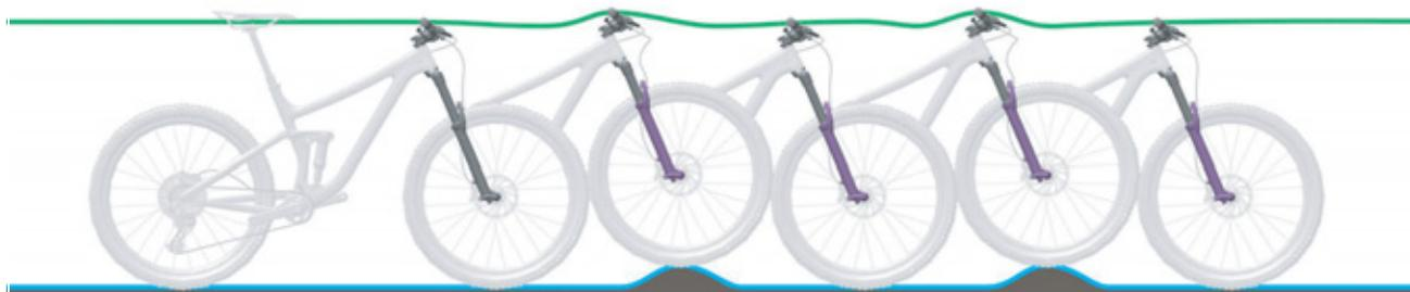
Figura 16: Comportamento di marcia ottimale della forcella
