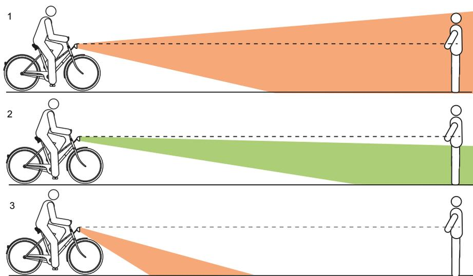
Figura 143: Luce regolata a un'altezza eccessiva (1), correttamente (2) e a un'altezza insufficiente (3)
