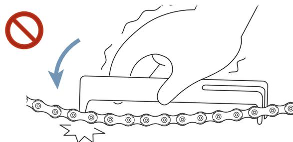
Figura 196: Il calibro di misura dell'usura entra tra due maglie
