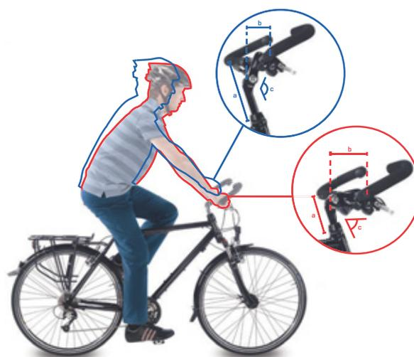
Figura 121: Posizione per bicicletta da città (blu) e per bicicletta da trekking (rosso) tramite modifica dell'angolo
