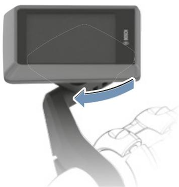
Figura 149: Rotazione del display in senso orario
