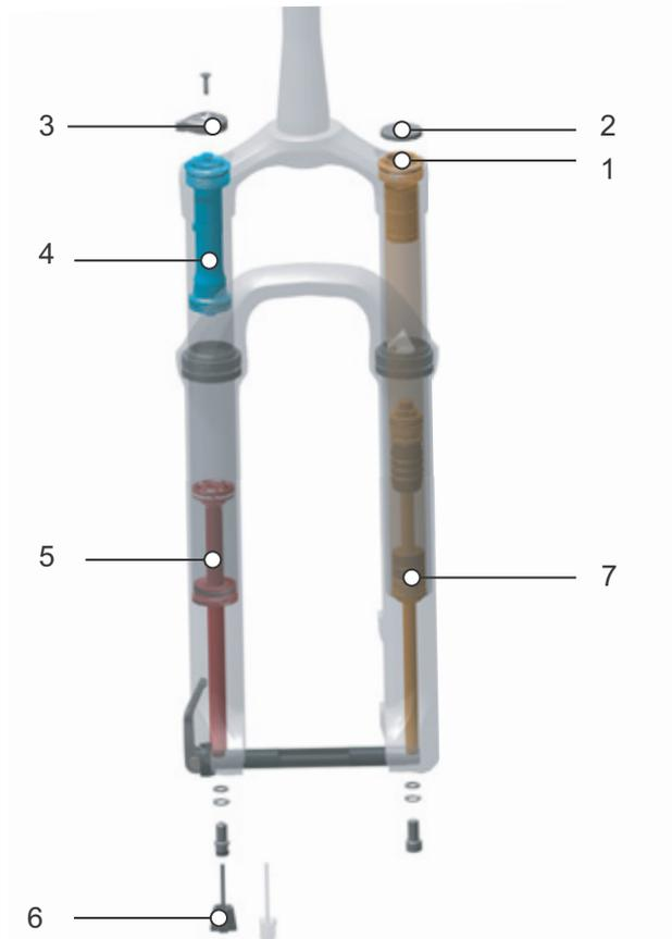
Figura 14: Struttura interna della forcella ammortizzata pneumatica
