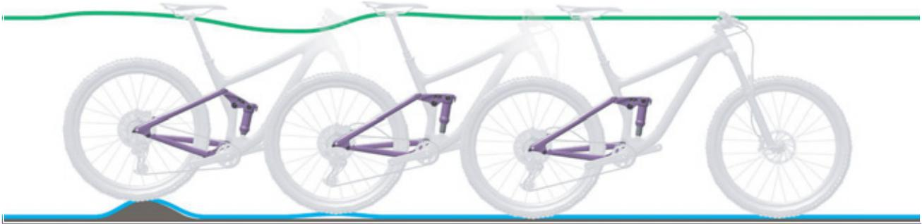
Figura 224: Corsa di estensione troppo veloce dell'ammortizzatore del carro posteriore
