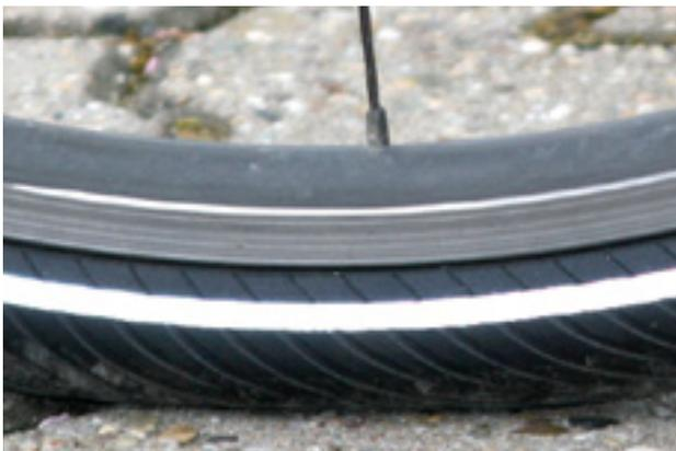
Figura 123: Corretta pressione di gonfiaggio. Lo pneumatico quasi non si deforma sotto il peso corporeo
