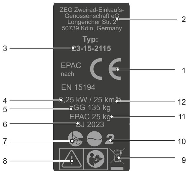
Figura 2: Esempio di targhetta di identificazione ZEG
