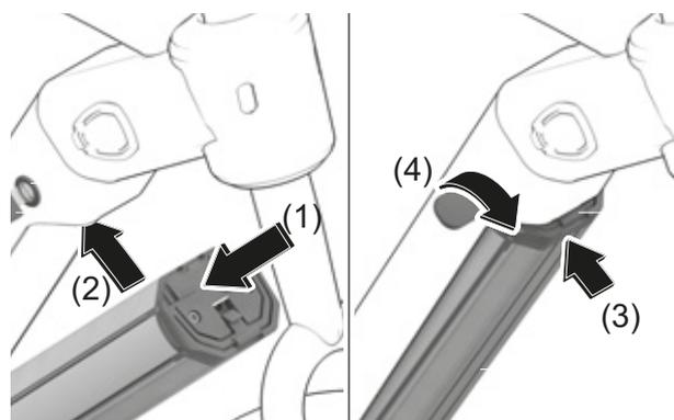
Figura 167: Montaggio della batteria integrata
