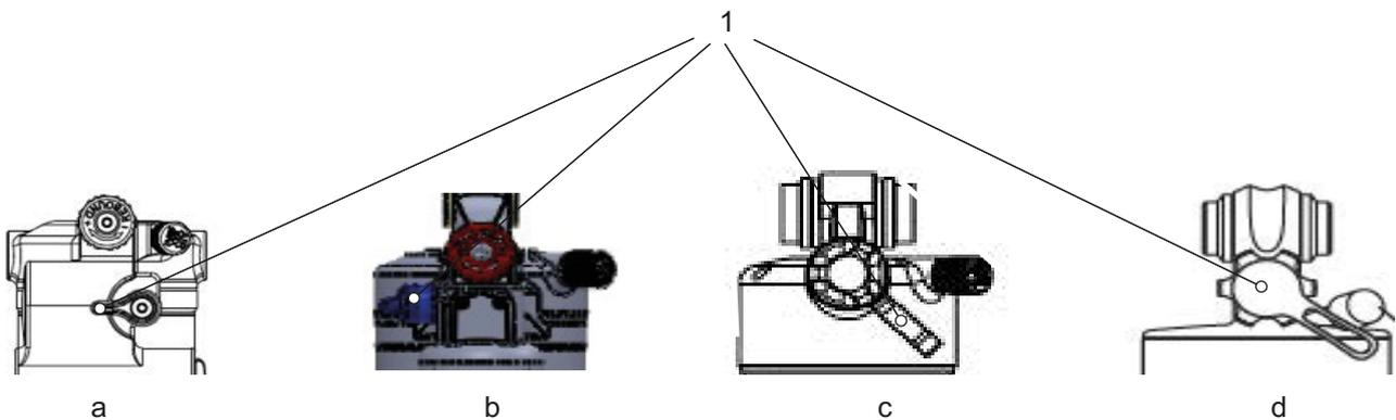
Figura 229: Posizione della leva degli stadi di pressione RS Suntour con ammortizzatore del carro posteriore Triair2 (a), Triair (b), EDGE-comp (c), EDGE (d)
