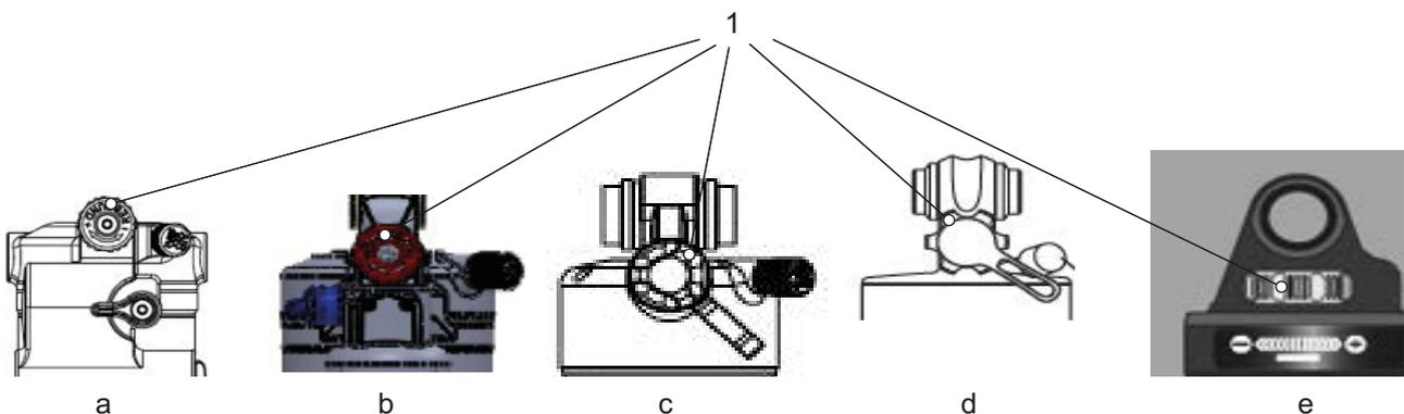
Figura 227: Posizione della manopola di regolazione del rebound RS Suntour con ammortizzatore del carro posteriore Triair2 (a), Triair (b), EDGE-comp (c), EDGE (d) e RAIDON (e)
