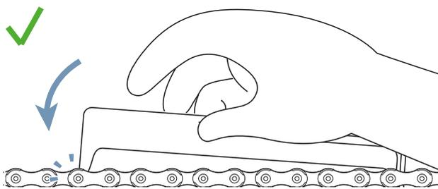
Figura 195: Il calibro di misura dell'usura non entra tra le maglie
