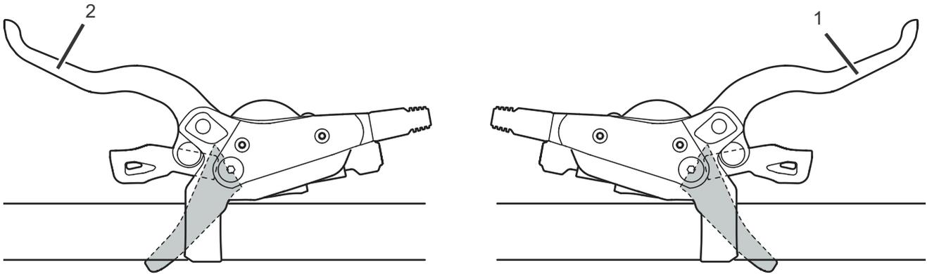
Figura 57: Freno a mano della ruota posteriore (1) e della ruota anteriore (2), esempio freno SHIMANO
