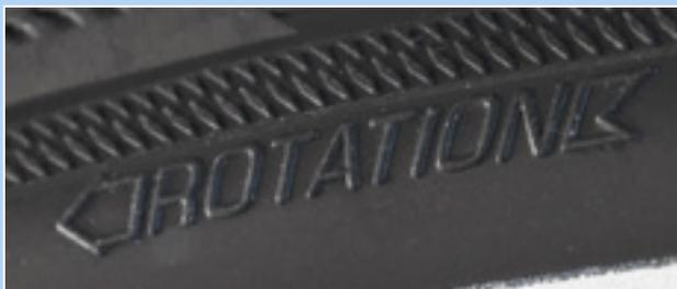
Figura 94: Freccia del senso di rotazione
