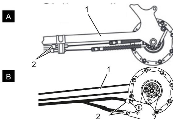
Figura 212: Boccole di regolazione (2) di due versioni alternative (A e B) di un cambio azionato da cavo doppio sul fodero orizzontale (1)
