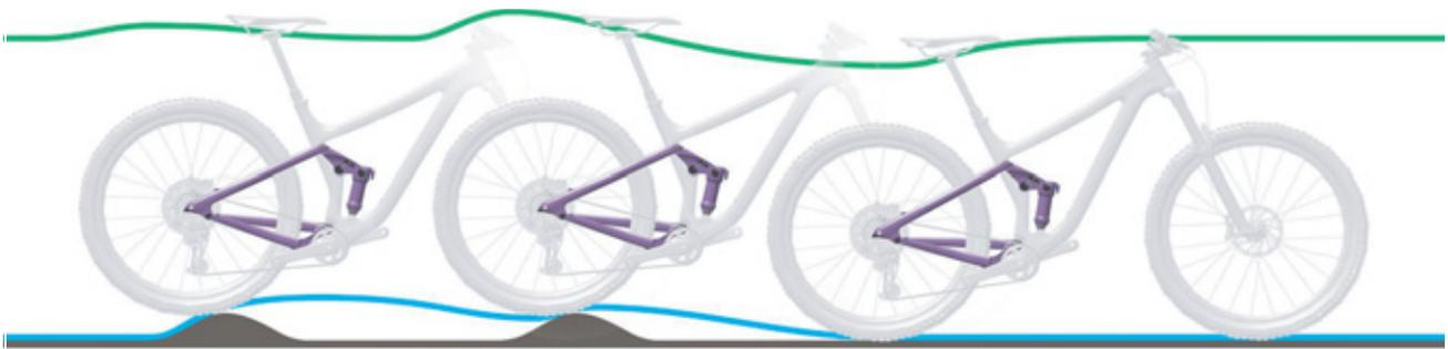
Figura 226: Corsa di estensione troppo lenta dell'ammortizzatore del carro posteriore
