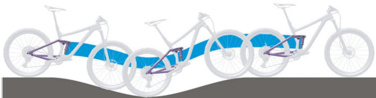
Figura 6: Comportamento di marcia ottimale dell'ammortizzatore del carro posteriore su un terreno con dossi
