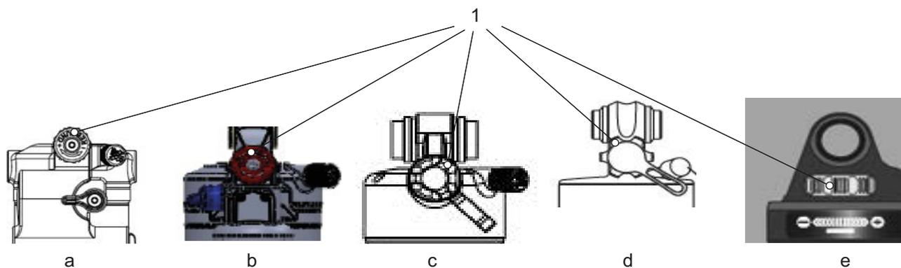
Figura 142: Posizione della manopola del rebound RS Suntour con ammortizzatore del carro posteriore Triair2 (a), Triair (b), EDGE-comp (c), EDGE (d) e RAIDON (e)
