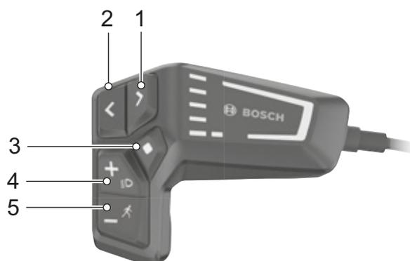
Figura 151: Terminali di comando BOSCH LED Remote
