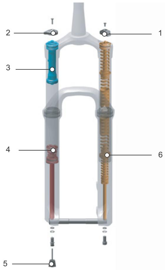
Figura 15: Struttura interna della forcella con molla in acciaio
