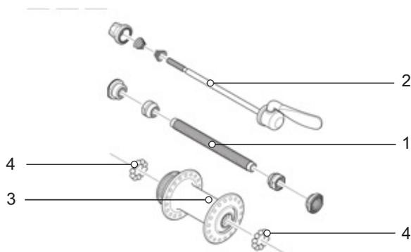
Figura 31: Esempio di mozzo della ruota anteriore, SHIMANO
