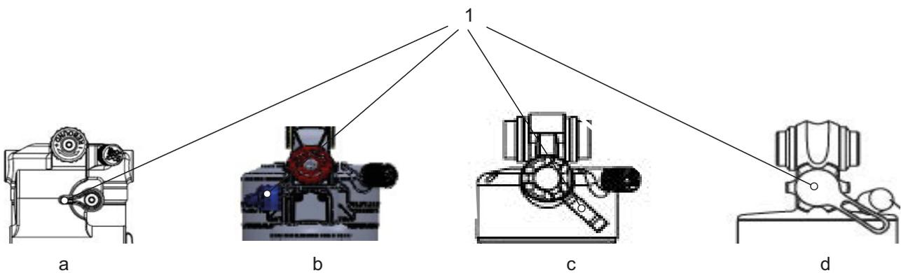
Figura 231: Posizione della leva degli stadi di pressione RS Suntour con ammortizzatore del carro posteriore Triair2 (a), Triair (b), EDGE-comp (c), EDGE (d)
