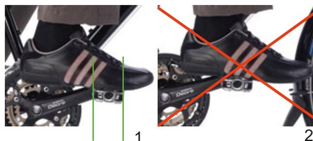
Figura 158: Posizione corretta (1) ed errata (2) del piede sul pedale
