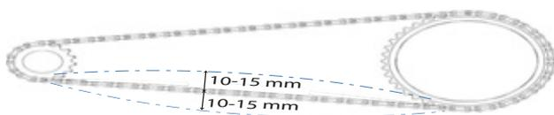
Figura 209: Controllo della tensione della catena
