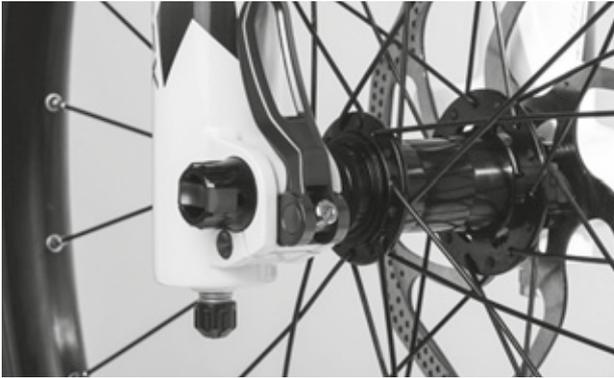
Figura 88: Corretta posizione della leva di serraggio
