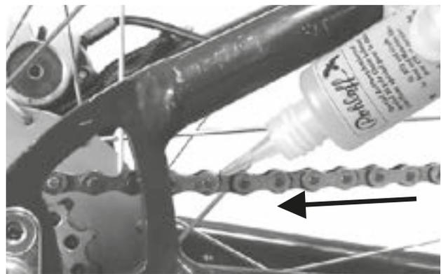
Figura 181: Lubrificazione della catena
