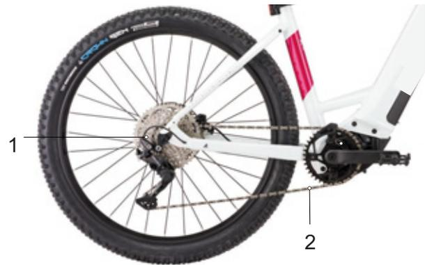
Figura 45: Schema della struttura a catena con cambio a catena
