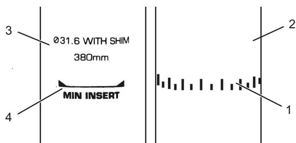
Figura 110: Particolare dei cannotti reggisella, esempi di segno indicante la minima profondità di inserimento
