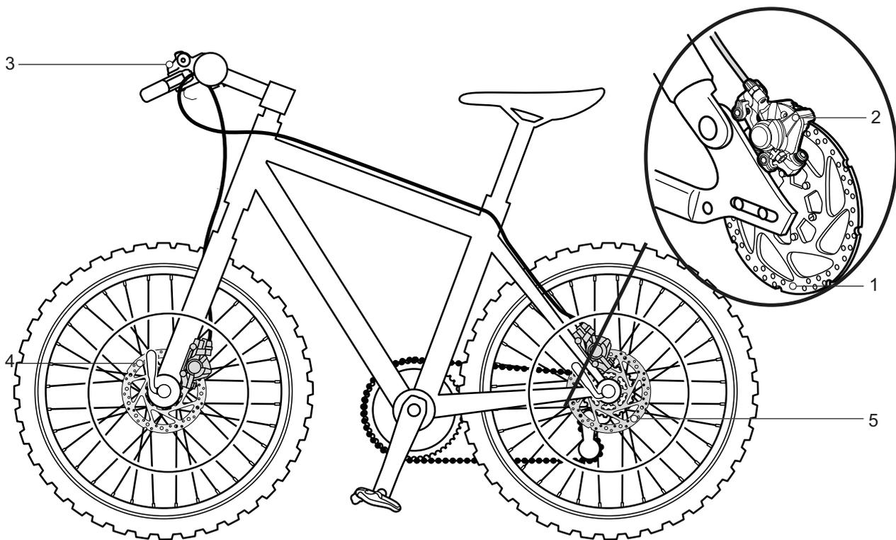
Figura 43: Sistema frenante con freno a disco, esempio
