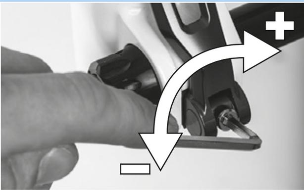
Figura 89: Regolazione della forza di serraggio del bloccaggio rapido
