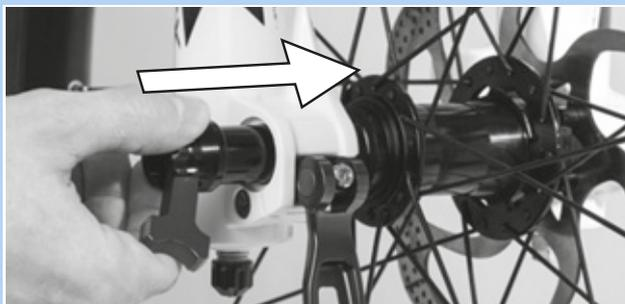
Figura 84: Inserimento del perno passante nel verso della freccia
