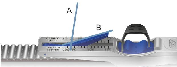
Figura 204: Esempio di lettura del valore: 20 kg
