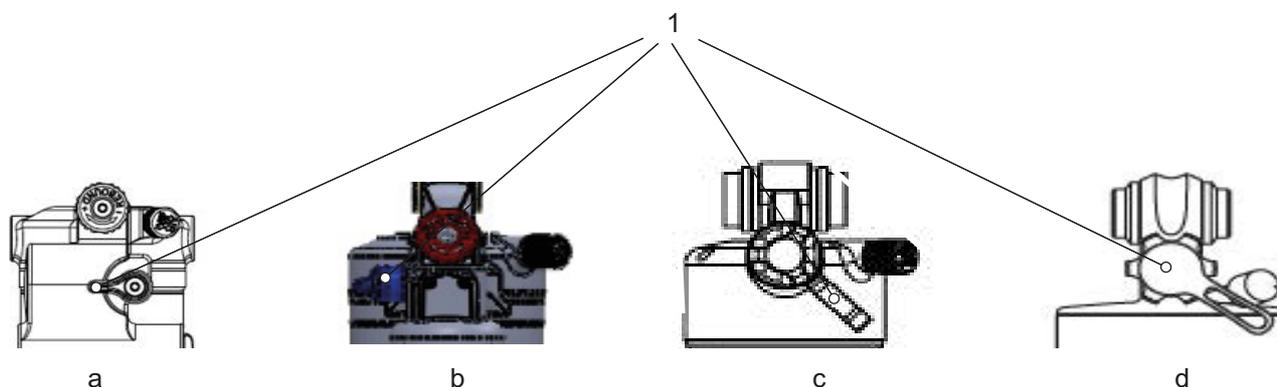
Figura 165: Posizione del regolatore dello stadio di compressione RS Suntour con ammortizzatore del carro posteriore Triair2 (a), Triair (b), EDGE-comp (c), EDGE (d)
