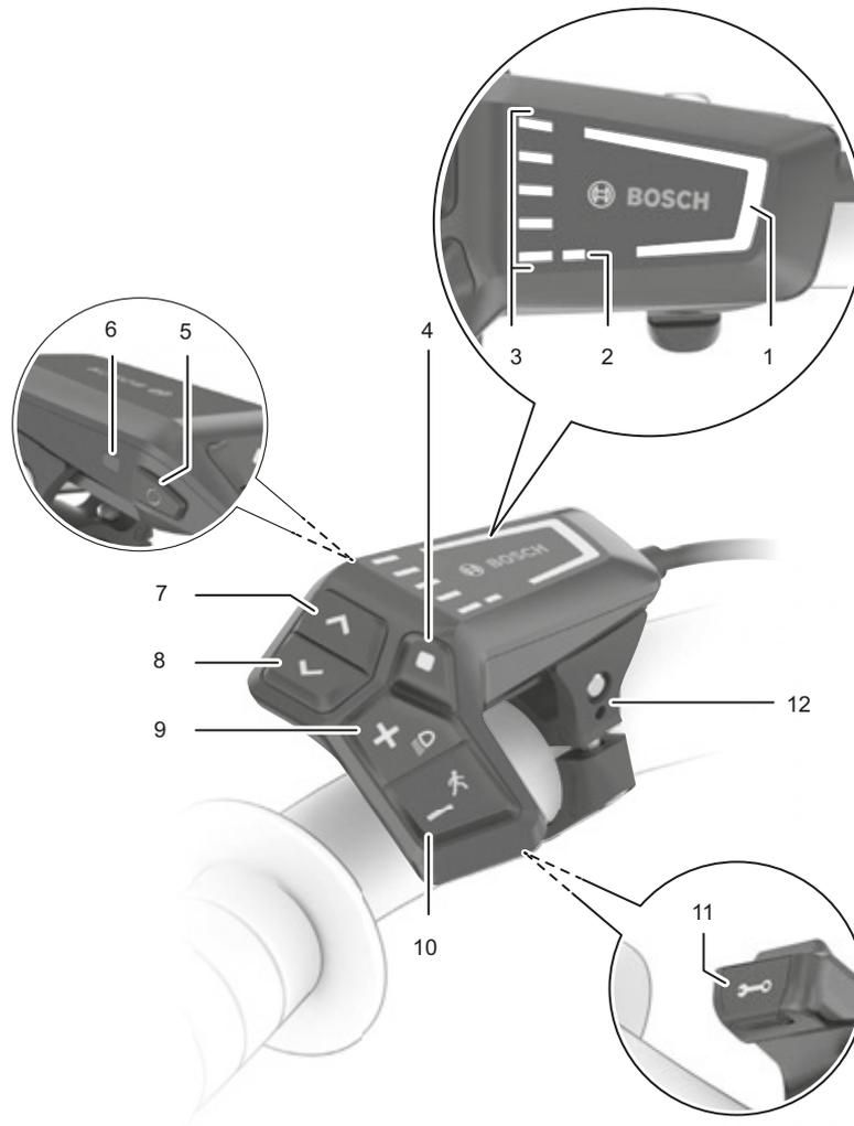
Figura 53: Schema del computer di bordo BOSCH LED Remote
