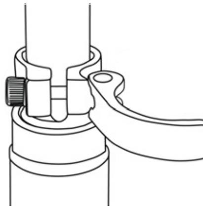
Figura 38: Esempio: bloccaggio rapido
