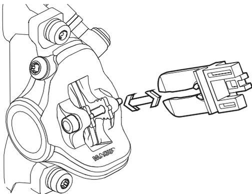
Figura 65: Fissaggio della sicura di trasporto
