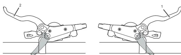
Figura 174: Leva del freno posteriore (1) e anteriore (2), esempio freno SHIMANO
