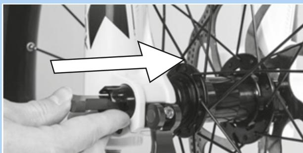
Figura 86: Inserimento della leva rossa nel verso della freccia
