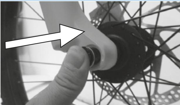
Figura 80: Insetimento del perno nel verso della freccia
