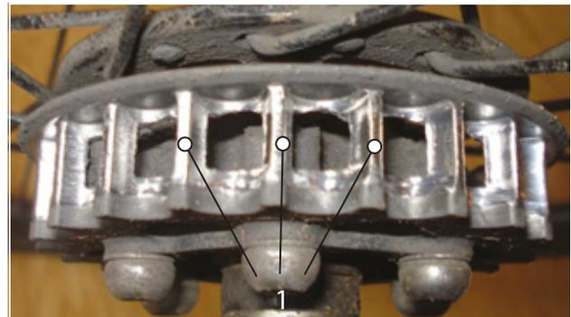
Figura 200: Esempio: profilo usurato dei denti
