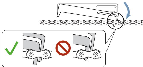
Figura 193: Inserimento del calibro di misura dell'usura
