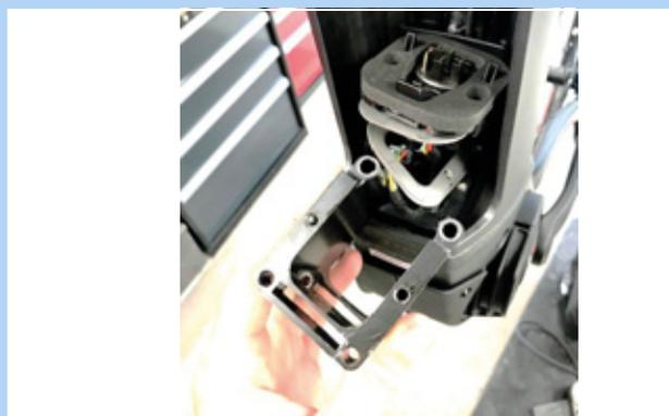
Figura 69: Estrazione dell'adattatore PowerTube
