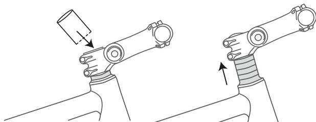
Figura 119: Aumento dell'altezza dell'attacco manubrio ahead tramite montaggio di distanziatori ad anello (spaziatori)
