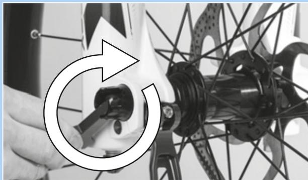
Figura 85: Serraggio del perno nel verso della freccia
