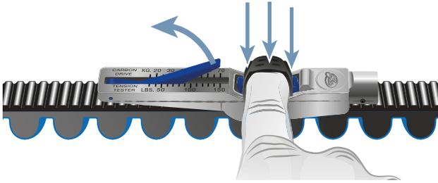
Figura 203: Spinta del calibro di verifica verso il basso con il dito
