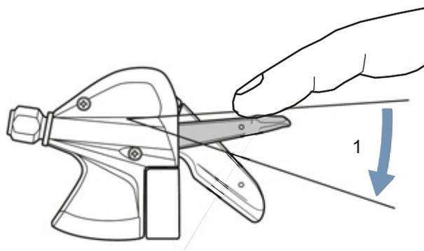
Figura 176: Cambio rapporto con la leva B, esempio cambio SL-M315
