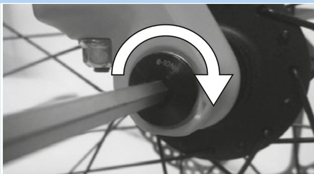
Figura 81: Serraggio del perno nel verso della freccia
