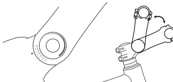
Figura 120: Differenti versioni di attacchi manubrio con angolazione variabile
