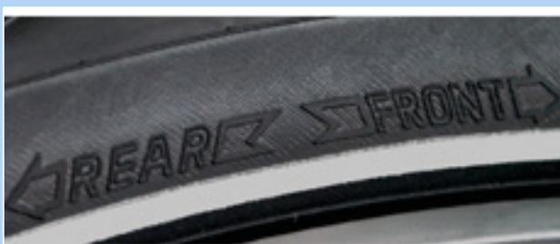
Figura 95: Freccia del senso di rotazione su pneumatici MTB
