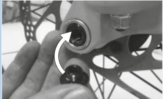
Figura 82: Applicazione della vite di sicurezza
