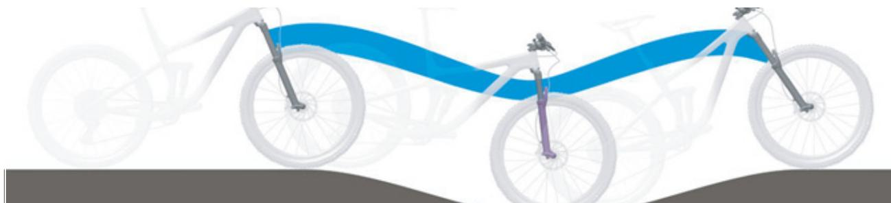
Figura 19: Comportamento di marcia ottimale su un terreno con dossi
