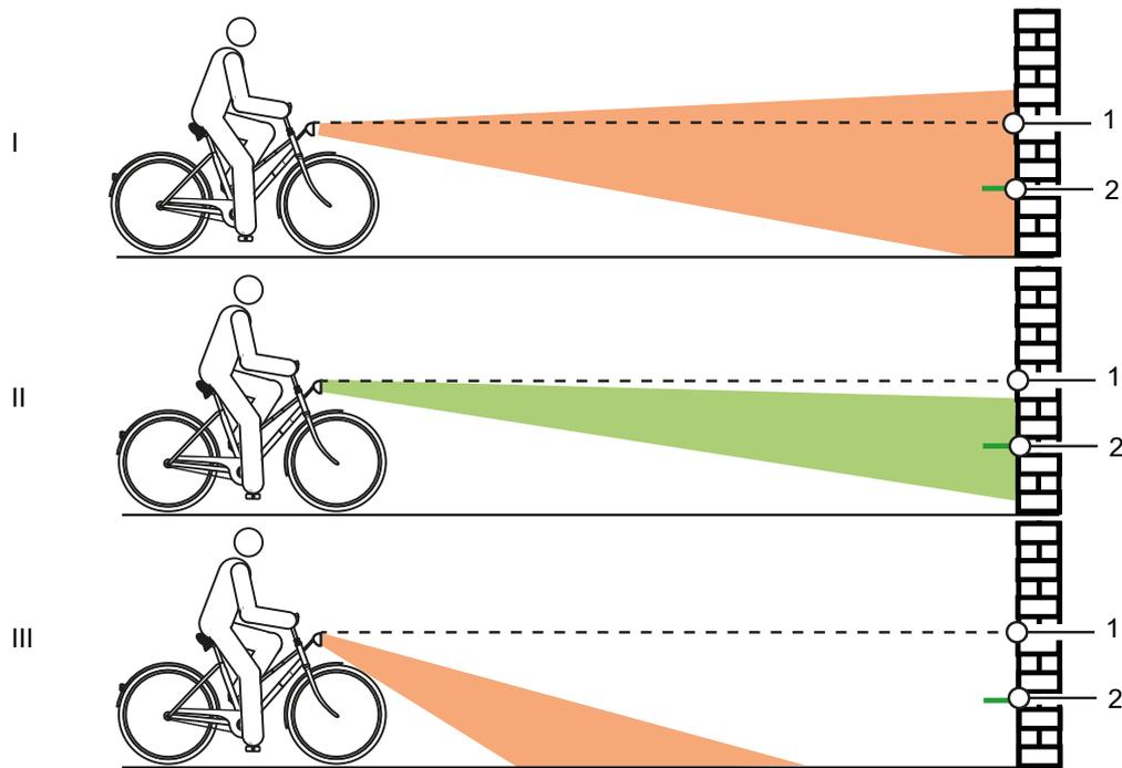
Figura 208: Luce regolata a un'altezza eccessiva (1), correttamente (2) e a un'altezza insufficiente (3)
