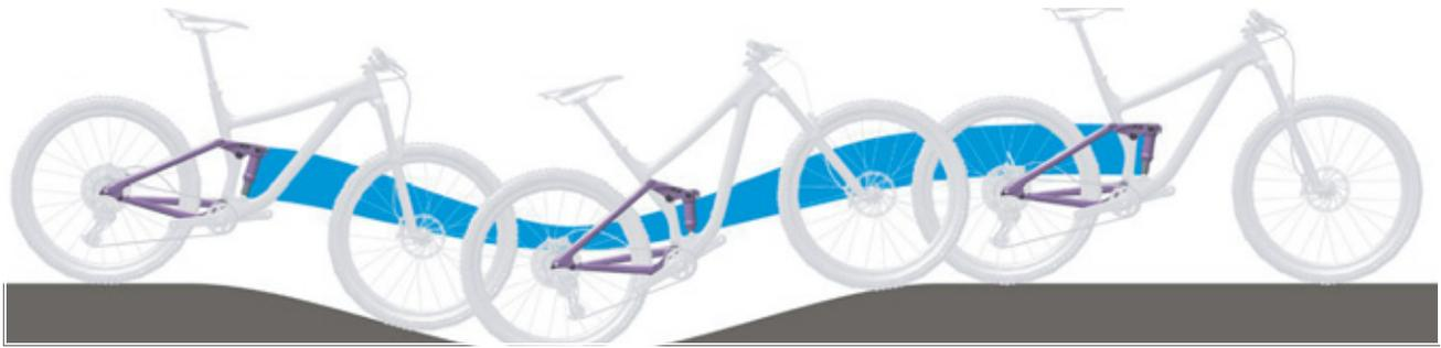
Figura 228: Sospensione dell'ammortizzatore del carro posteriore troppo morbida in salita
