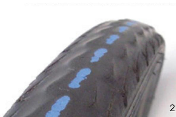
Figura 184: Pneumatico senza profilo che può essere sostituito (1) e pneumatico con protezione contro le forature in vista (2) che deve essere sostituito
