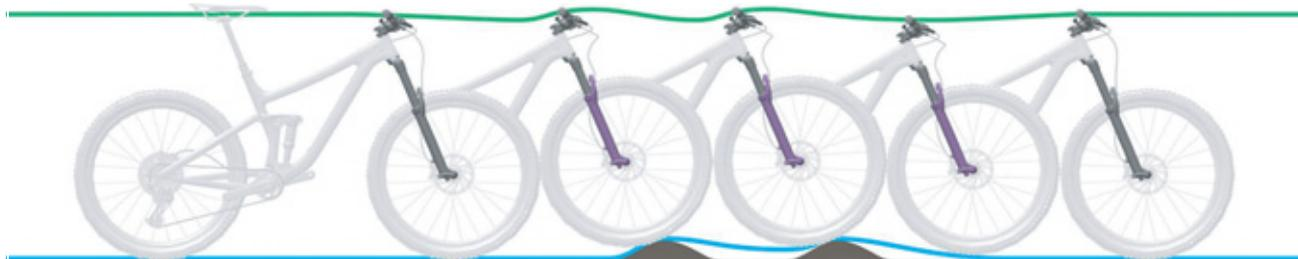
Figura 220: Corsa di estensione troppo lenta della forcella ammortizzata
