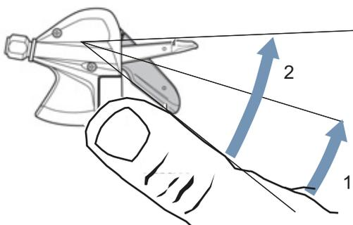
Figura 175: Cambio rapporto con la leva A, esempio cambio SL-M315
