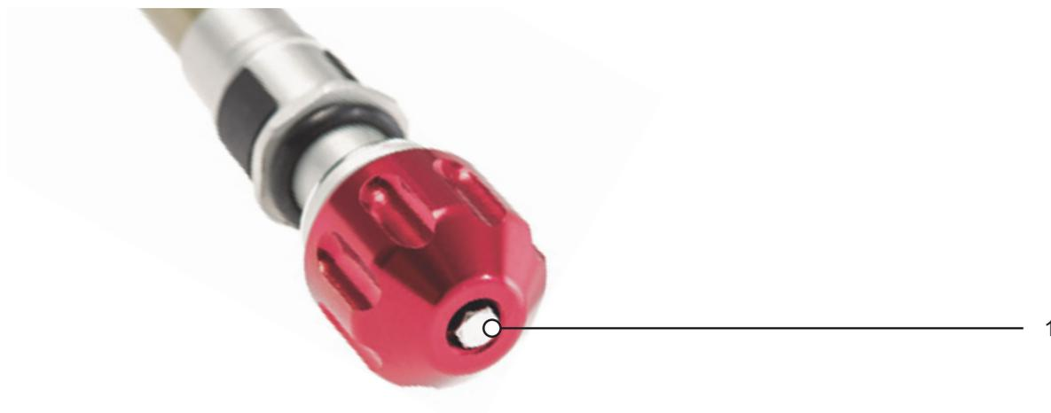
Figura 219: Esempio di vite del rebound (1) SR SUNTOUR
