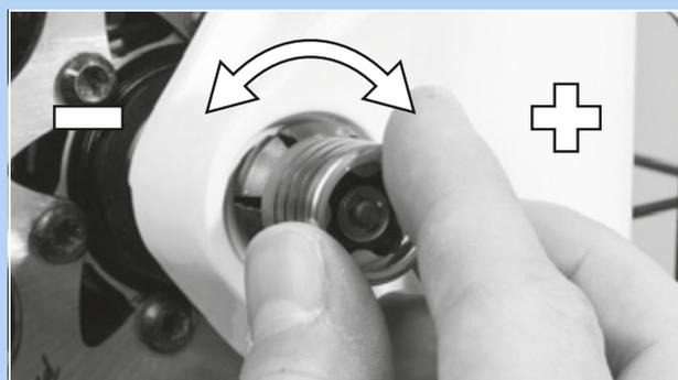
Figura 92: Regolazione del serraggio
