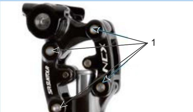
Figura 216: Punti di lubrificazione del canotto reggisella ammortizzato SR SUNTOUR
