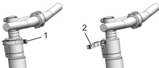
Figura 116: Leva di serraggio dell'attacco manubrio chiusa (1) e aperta (2), esempio All Up
