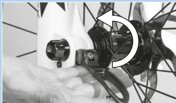
Figura 87: Spinta della leva del bloccaggio rapido nel verso della freccia
