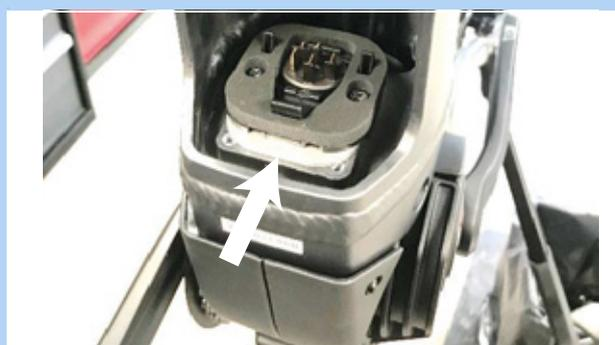
Figura 70: Piastre dell'adattatore incorporate
