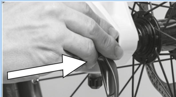
Figura 91: Inserimento del bloccaggio rapido nel verso della freccia
