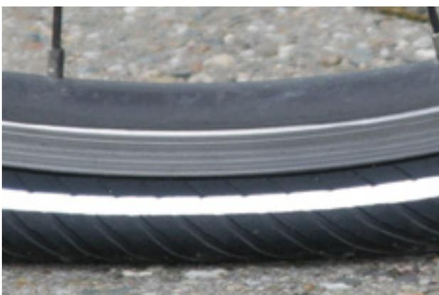
Figura 124: Pressione di gonfiaggio insufficiente
