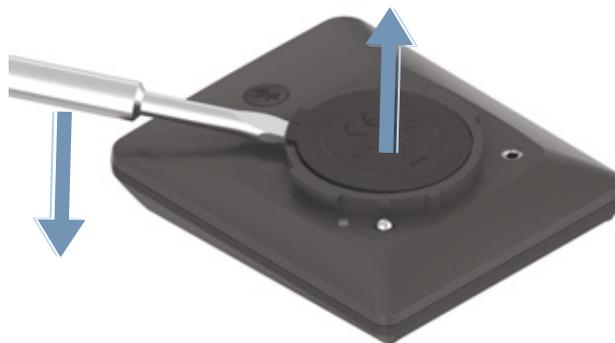
Figura 146: Sollevamento del coperchio del vano della batteria
