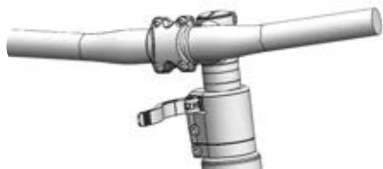
Figura 154: Esempio: All Up con leva di serraggio dell'attacco manubrio aperta
