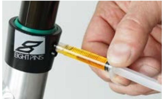
Figura 182: Lubrificazione del cannotto reggisella Eightpins
