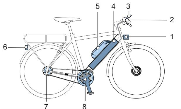
Figura 47: Schema del sistema di trazione elettrica con componenti elettrici
