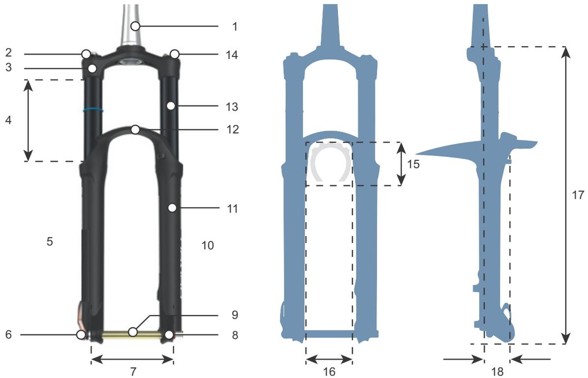
Figura 13: Struttura della forcella ammortizzata
