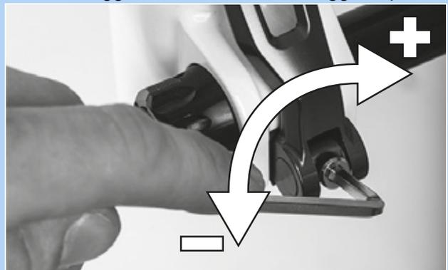
Figura 215: Regolazione della forza di serraggio del bloccaggio rapido
