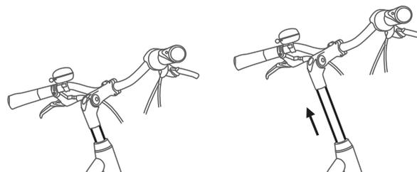
Figura 118: Regolazione dell'altezza dell'attacco manubrio a canotto
