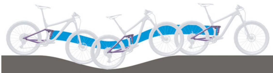
Figura 136: Comportamento di marcia ottimale dell'ammortizzatore del carro posteriore su un terreno con dossi
