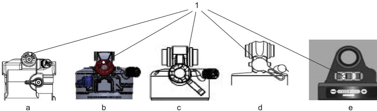
Figura 225: Posizione della manopola di regolazione del rebound RS Suntour con ammortizzatore del carro posteriore Triair2 (a), Triair (b), EDGE-comp (c), EDGE (d) e RAIDON (e)
