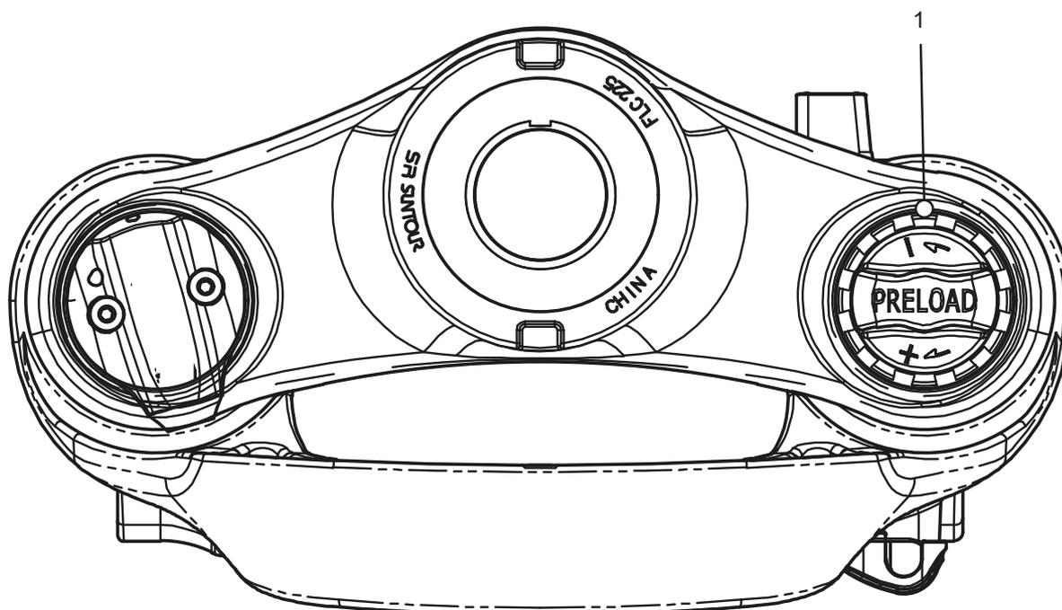
Figura 133: Esempio SR SUNTOUR, manopola di regolazione della SAG sulla corona della forcella
