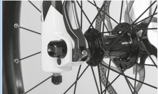
Figura 214: Regolazione della forza di serraggio del bloccaggio rapido
