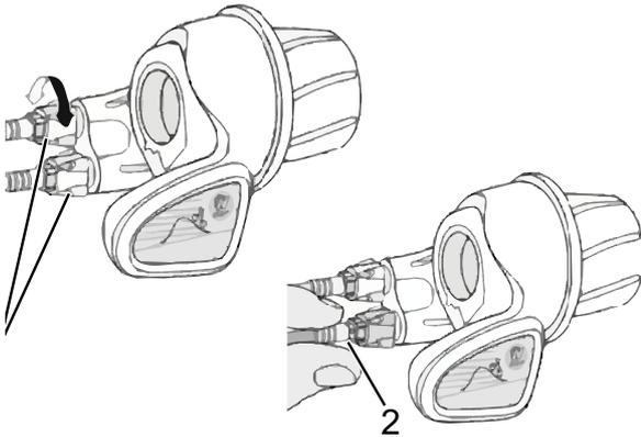
Figura 213: Interruttore a manopola con boccole di regolazione (1) con gioco angolare (2)
