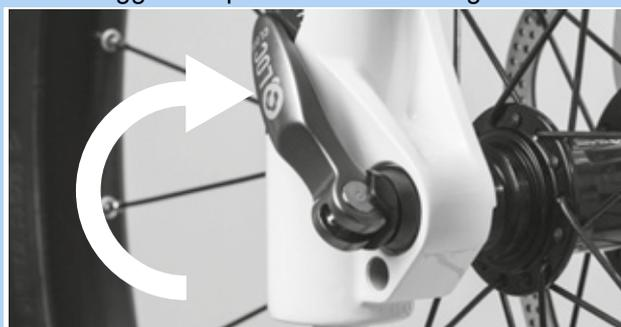
Figura 93: Chiusura del bloccaggio rapido
