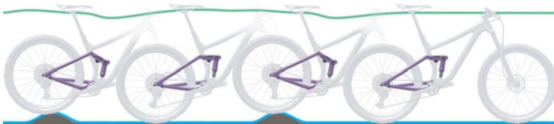
Figura 135: Comportamento di marcia ottimale dell'ammortizzatore del carro posteriore
