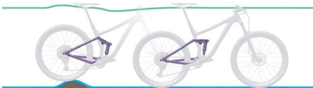
Figura 137: Comportamento di marcia ottimale dell'ammortizzatore del carro posteriore su asperità
