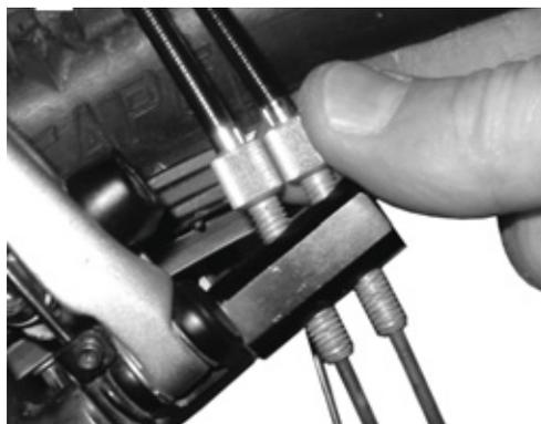
Figura 210: Le versioni del mozzo ROHLOFF con comando interno del cambio hanno i regolatori del tensionamento sul controsupporto di tensionamento
