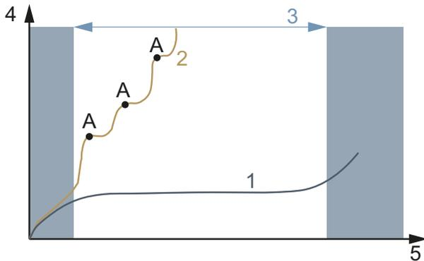
Figura 180: Diagramma dell'usura, asportazione di materiale (y) in funzione della durata di funzionamento (x)
