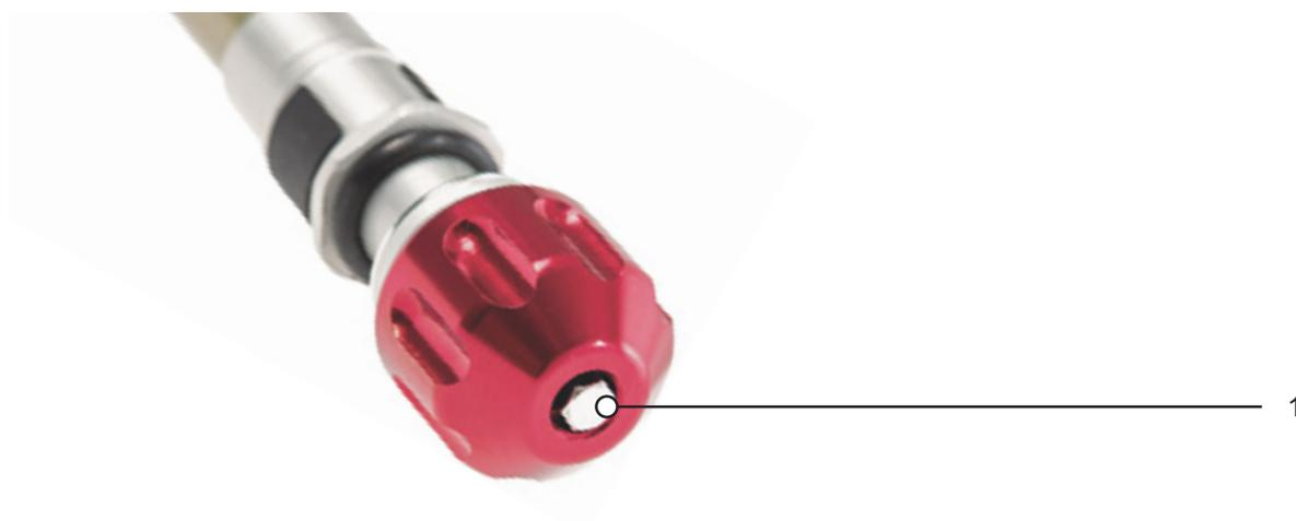
Figura 221: Esempio di vite del rebound (1) SR SUNTOUR
