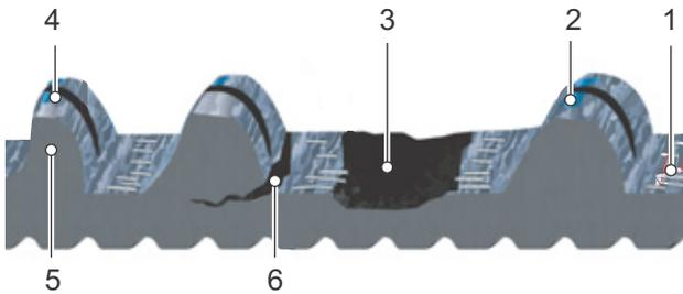
Figura 197: Caratteristiche di usura di una cinghia
