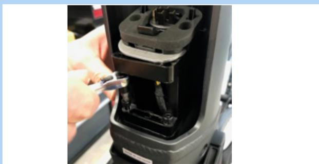
Figura 67: Rimozione delle viti a testa esagonale da 4 mm
