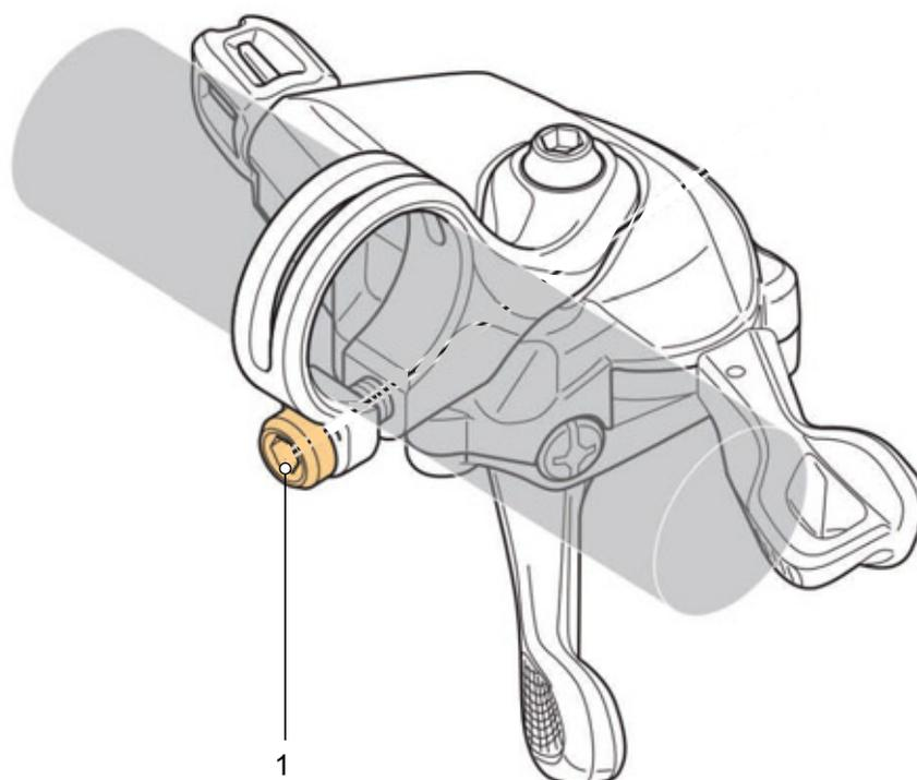
Figura 129: Ubicazione della vite di fissaggio della leva del cambio SHIMANO (1)
