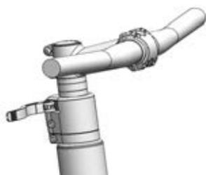
Figura 177: Esempio: All Up con leva di serraggio dell'attacco manubrio aperta
