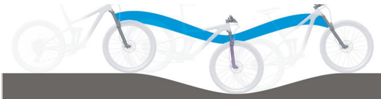
Figura 17: Comportamento di marcia ottimale della forcella su un terreno con dossi
