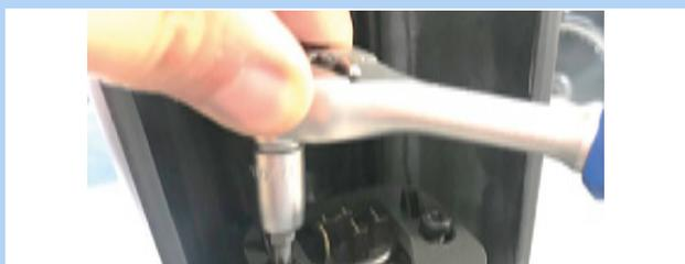
Figura 66: Svitare le viti del portabatteria
