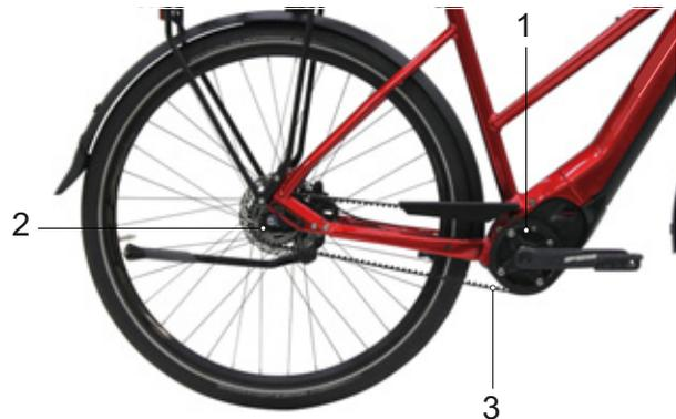
Figura 46: Schema della trasmissione a cinghia
