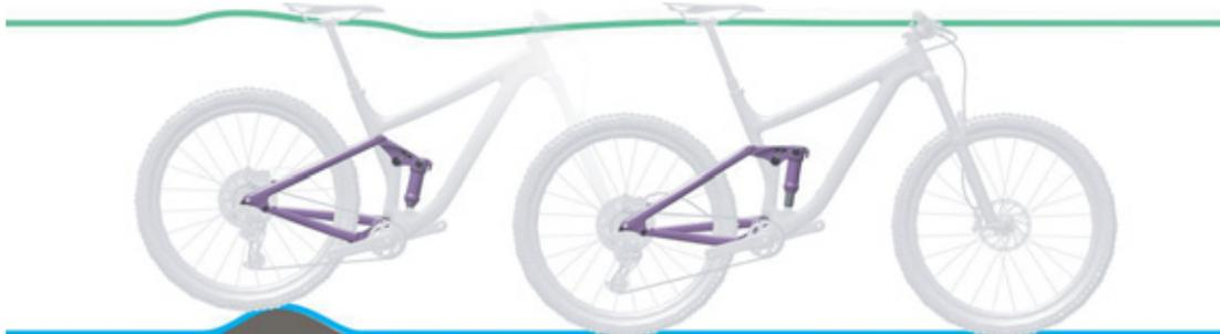
Figura 7: Comportamento di marcia ottimale dell'ammortizzatore del carro posteriore su asperità
