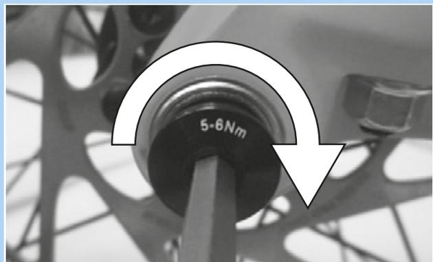
Figura 83: Serraggio della vite di sicurezza
