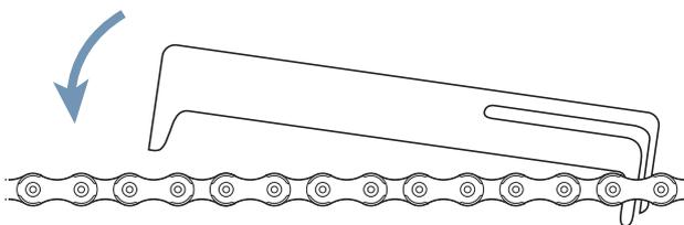
Figura 194: Abbassamento del calibro di misura dell'usura a sinistra
