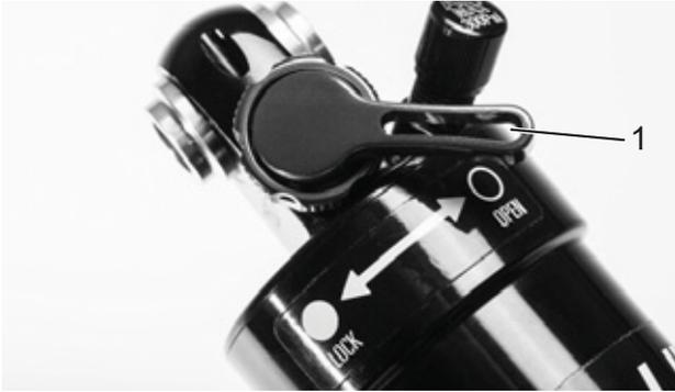
Figura 77: Regulador de niveles de presión Suntour abierto (1)
