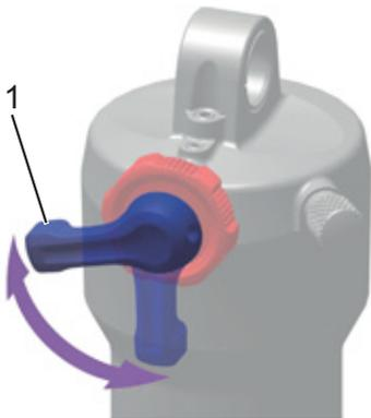
**Figura 80: Ajuste de la dureza del amortiguador de niveles de presión en la palanca (1) del amortiguador de la horquilla trasera**
