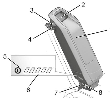
Figura 16: Detalle de la batería en el cuadro
