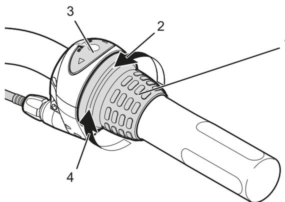
Figura 82: Ejemplo cambio de marchas Shimano Nexus: puño giratorio (1) del cambio de buje con su visualización (2), sentido de giro para aumentar la marcha (2) y el sentido de giro para reducir la marcha (4).
