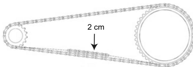
Figura 83: Comprobación de la tensión de la cadena
