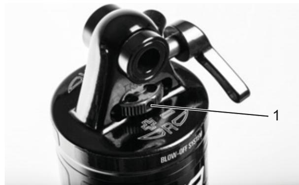
Figura 61: Rueda del regulador de niveles de tracción Suntour (1) en el amortiguador de la horquilla trasera
