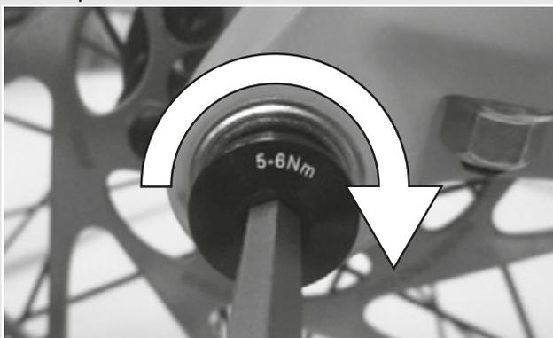
Figura 28: Apriete del tornillo de seguridad
