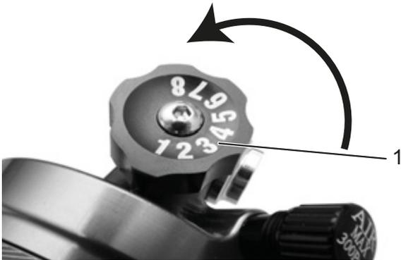
Figura 62: Regulador de niveles de presión Suntour en el amortiguador de la horquilla trasera
