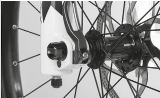
Figura 35: Posición perfecta de la palanca tensora
