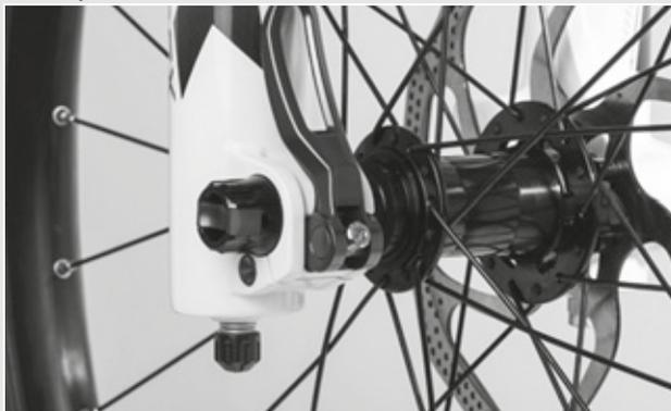
Figura 34: Posición perfecta de la palanca tensora
