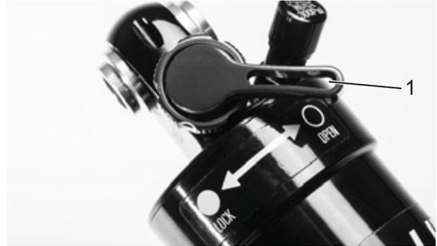
Figura 75: Regulador de niveles de presión Suntour abierto (1)
