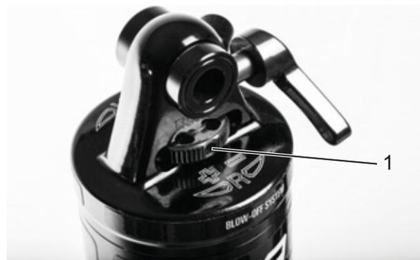
**Figura 60: Rueda del regulador de niveles de tracción Suntour (1) en el amortiguador de la horquilla trasera**
