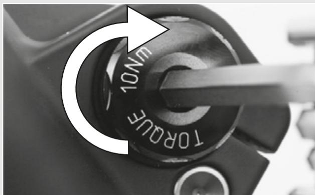
Figura 28: Apriete del eje insertado
