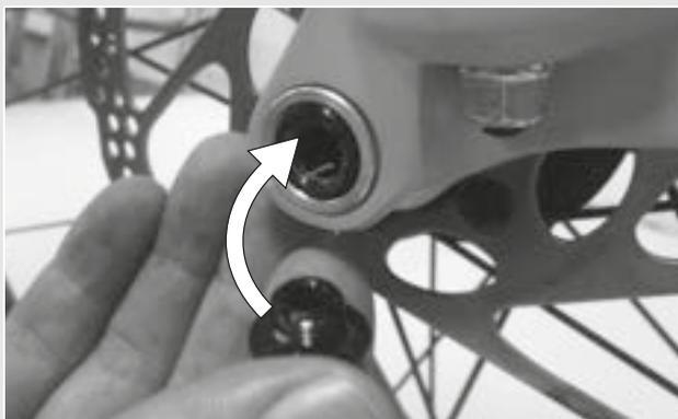
Figura 26: Inserción de la palanca de cierre rápido en el eje
