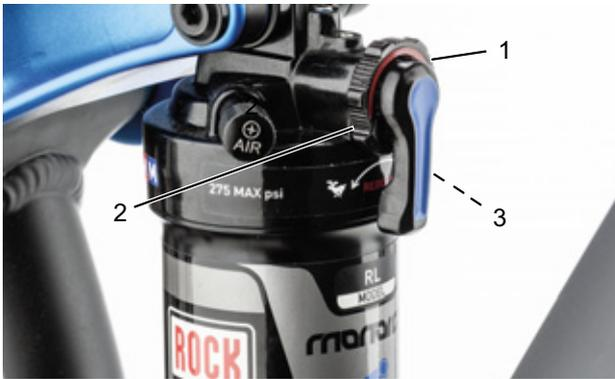
Figura 77: Ajuste de la dureza del amortiguador de niveles de tracción en la rueda de ajuste (1) del amortiguador de la horquilla trasera
