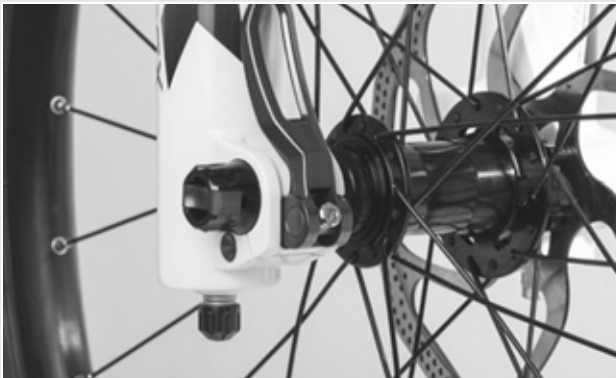
Afbeelding 35: Spankracht van de snelspanner afstellen
