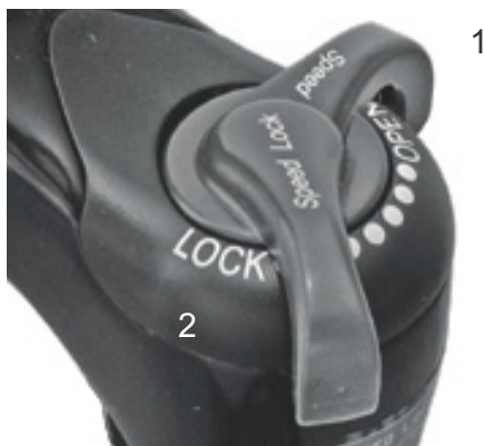
Rysunek 55: Nastawnik dobicia Suntour z pozycjami OPEN (1) i LOCK (2)
