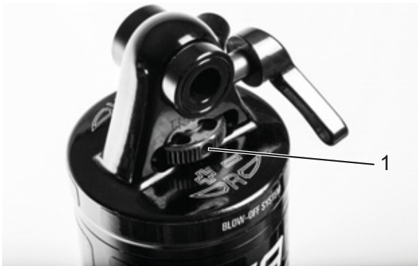
Illustration 274 : Molette de réglage de la détente Suntour (1) sur l'amortisseur arrière
