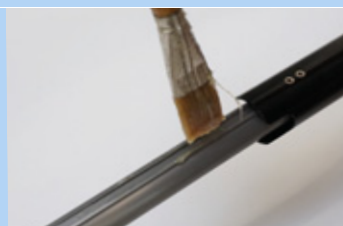
Illustration 249 : Appliquer de la graisse
