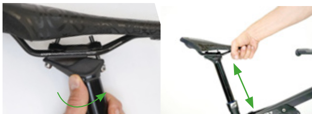
Illustration 95 : Régler la hauteur de la tige de selle
