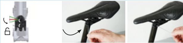
Illustration 195 : Placer le mécanisme de réglage de la hauteur en « position ouverte »
