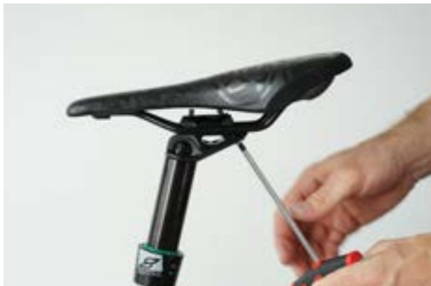
Illustration 101 : Desserrez la vis arrière
