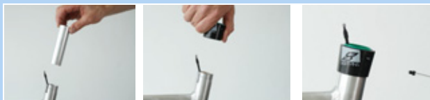
Illustration 252 : Monter la douille de glissement et l'enveloppe extérieure
