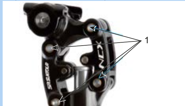
Illustration 194 : Points de lubrification de la tige de selle suspendue SR Suntour
