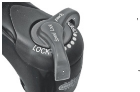
Illustration 264 : Régler le dispositif de réglage de la compression sur un niveau plus souple
