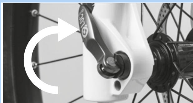
Illustration 83 : Fermer l'attache rapide
