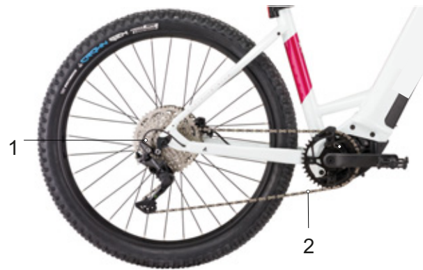
Illustration 34 : Schéma de l'entraînement à chaîne avec dérailleur
