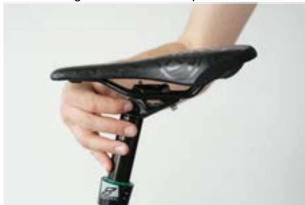
Illustration106: Régler l'inclinaison de la selle avec la molette de réglage
