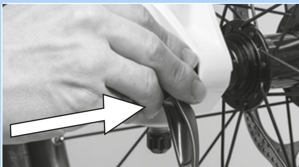
Illustration 81 : Enfoncez l'attache rapide dans le sens de la flèche
