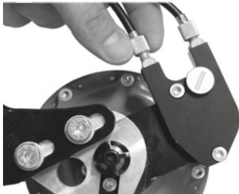
Illustration 188 : Sur les versions de moyeux ROHLOFF avec commande externe du changement de vitesse, le dispositif de réglage de la tension est situé sur le boîtier de câbles qui est placé sur le côté gauche.
