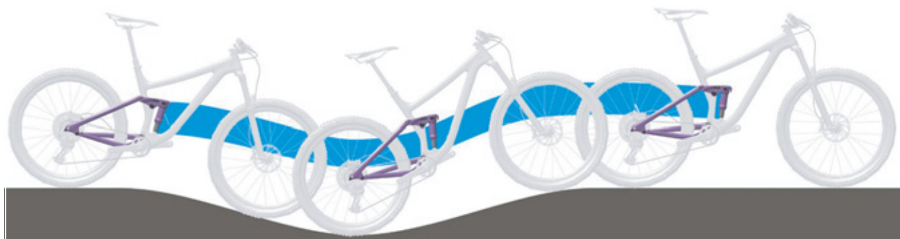
Illustration 22 : Comportement optimal de l'amortisseur arrière en terrain vallonné
