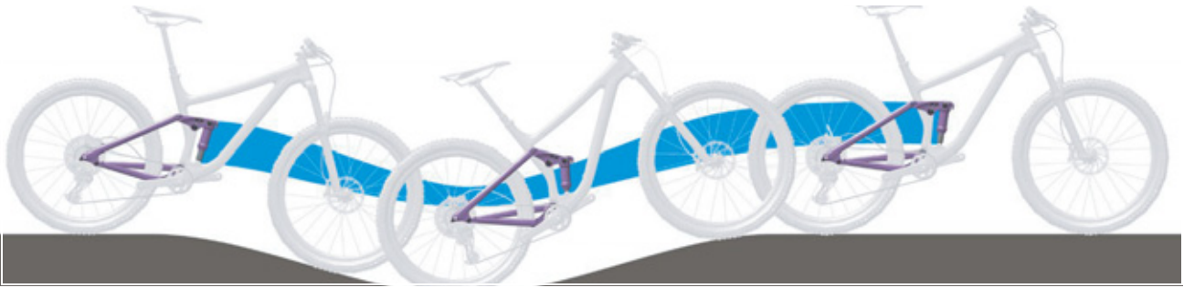
Illustration 285 : Suspension trop souple de l'amortisseur arrière dans les côtes
