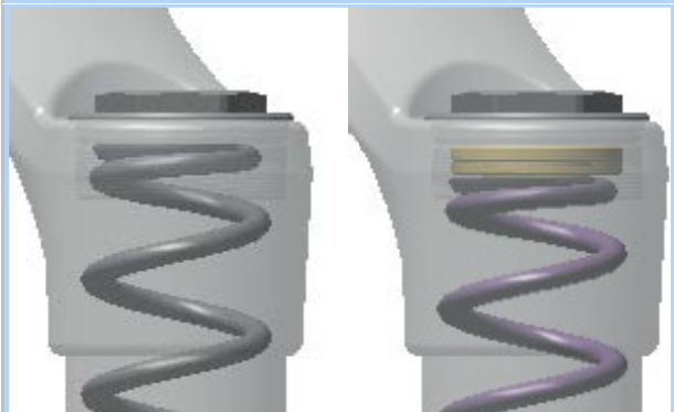
Illustration 137 : Serrer et desserrer l'anneau de réglage de la prétension
