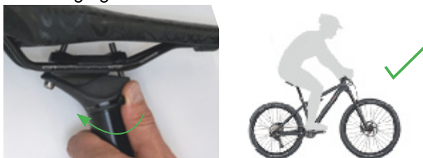
Illustration 96 : Serrer l'axe de la tige de selle
