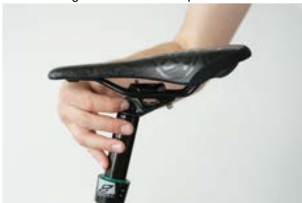
Illustration 102 : Régler l'inclinaison de la selle avec la molette de réglage
