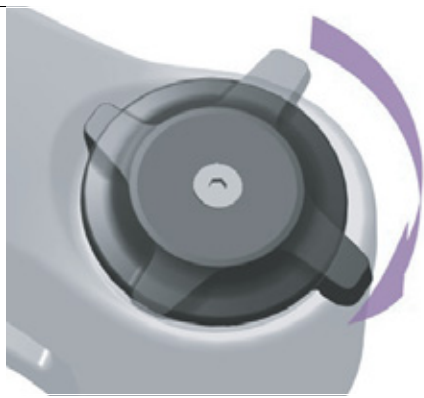
Illustration 270 : Régler le dispositif de réglage de la compression sur un niveau plus dur
