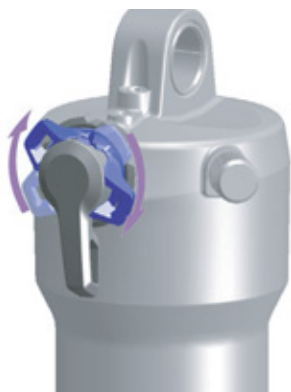
Illustration 149 : Régler le dispositif de réglage de la compression sur un niveau plus dur
