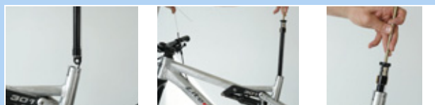
Illustration 223 : Fixer le couvercle de valve de la cartouche
