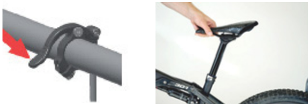
Illustration 94 : Sortir le ressort hydraulique à pression de gaz
