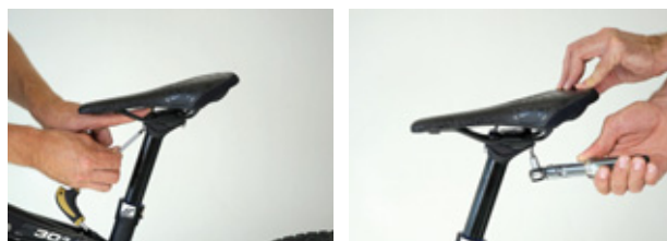
Illustration 100 : Fixer les vis avant et arrière
