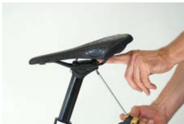
Illustration 99 : Desserrez la vis arrière
