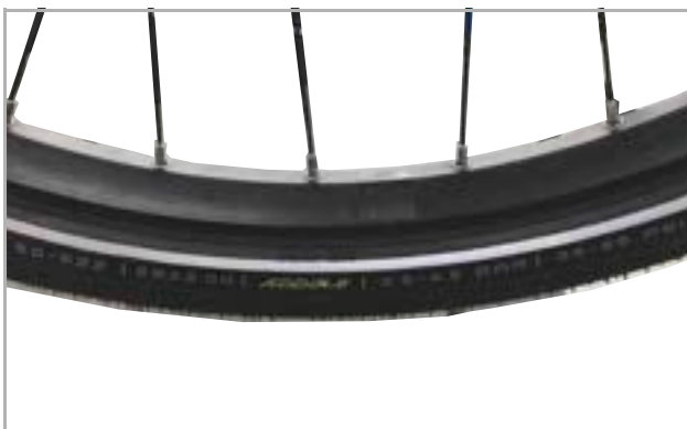
Figura 29: Esempio: Informazioni riportate sullo pneumatico
