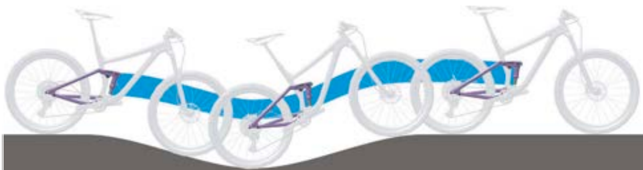
Figura 9: Comportamento di marcia ottimale dell'ammortizzatore del carro posteriore su un terreno con dossi
