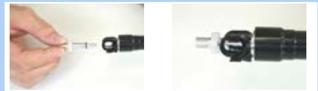
Figura 263: Avvitamento dell'adattatore della valvola
