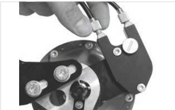
Figura 240: Le versioni del mozzo ROHLOFF con comando esterno del cambio hanno i regolatori del tensionamento sulla scatola dei cavi situata sul lato sinistro
