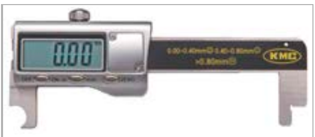
Figura 221: Esempio di calibro digitale di misura dell'usura KMC
