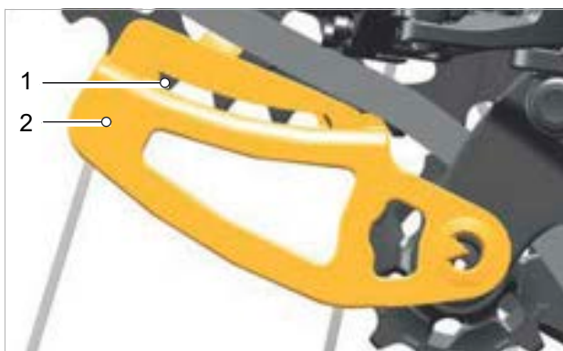
Figura 154: Finestra (1) con denti del calibro Chain Gap (2)
