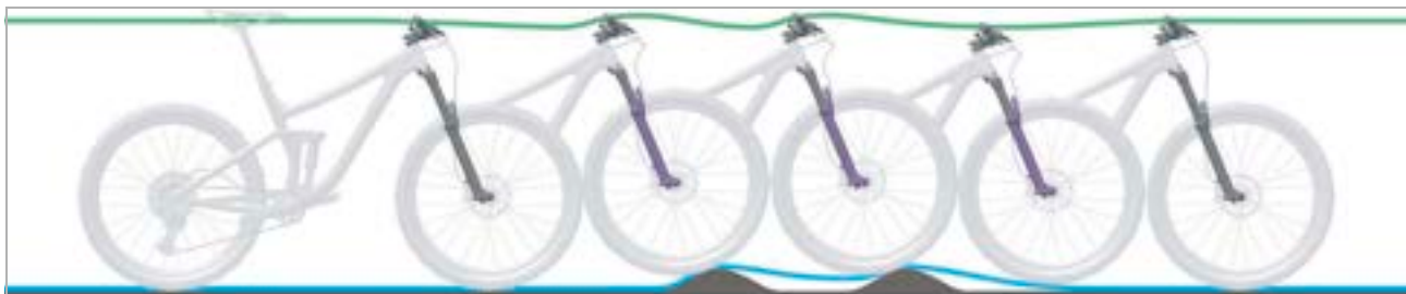
Figura 319: Corsa di estensione troppo lenta della forcella ammortizzata
