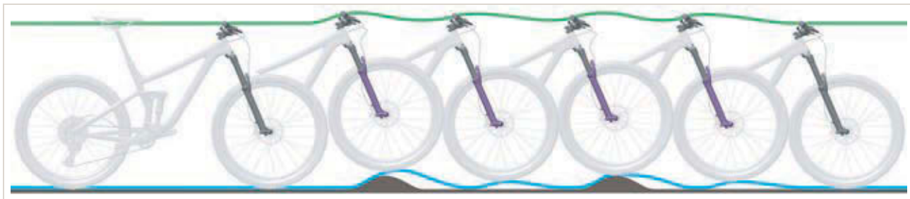
Figura 309: Corsa di estensione troppo veloce della forcella ammortizzata
