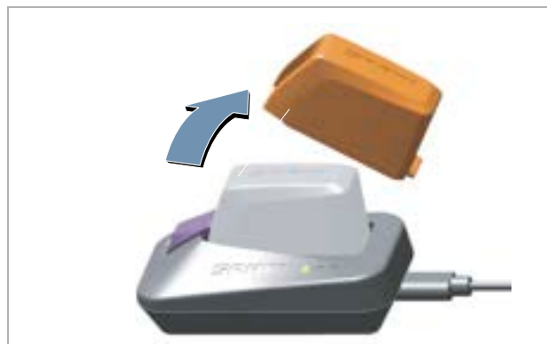
Figura 350: Rimozione della copertura della batteria
