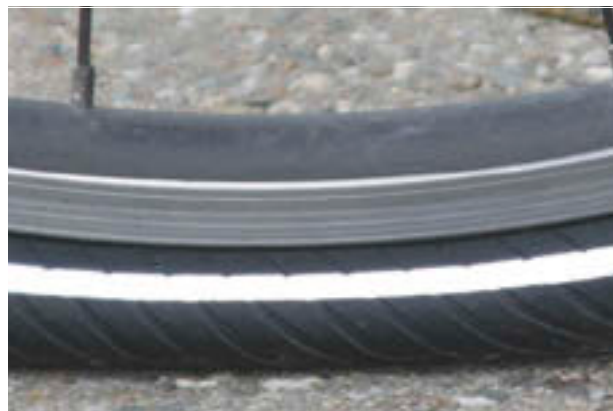
Figura 144: Pressione di gonfiaggio insufficiente
