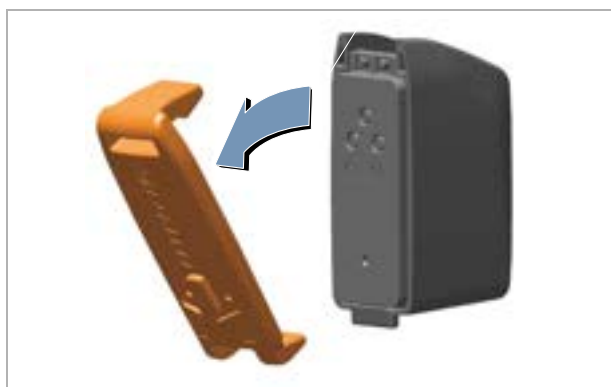
Figura 347: Rimozione della copertura della batteria
