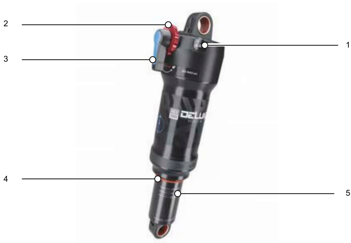
Figura 69: Struttura ammortizzatore del carro posteriore ROCKSHOX Deluxe Select +
