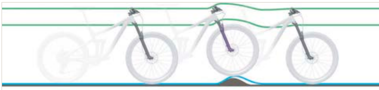
Figura 315: Smorzamento troppo rigido della forcella ammortizzata su asperità
