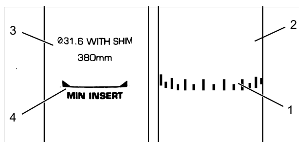
Figura 121: Particolare dei cannotti reggisella, esempi di segno indicante la minima profondità di inserimento
