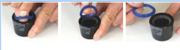
Figura 291: Estrazione del parapolvere
