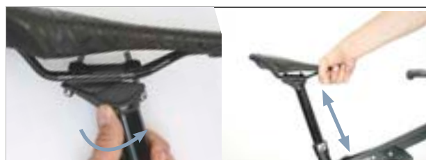
Figura 123: Regolazione dell'altezza del canotto reggisella
