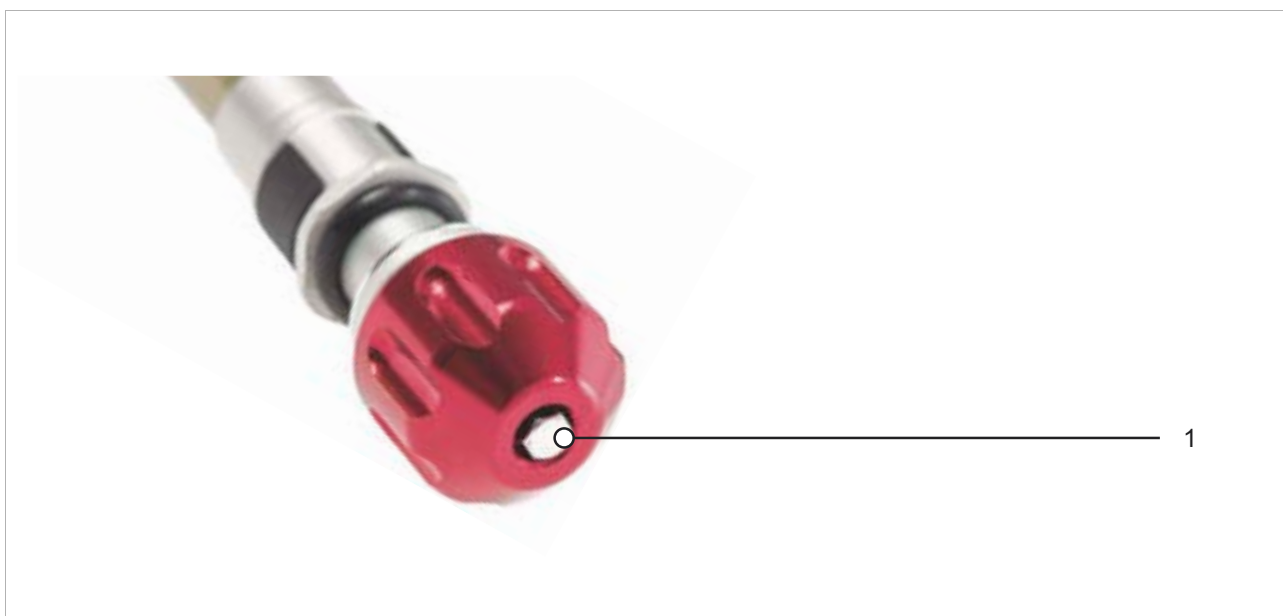
Figura 175: Esempio di regolatore del rebound (forcella ammortizzata) SR SUNTOUR (1)
