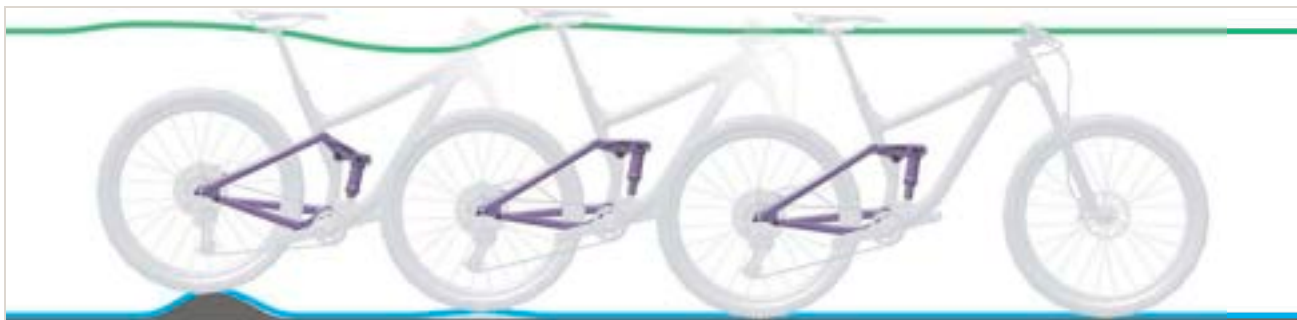
Figura 323: Corsa di estensione troppo veloce dell'ammortizzatore del carro posteriore
