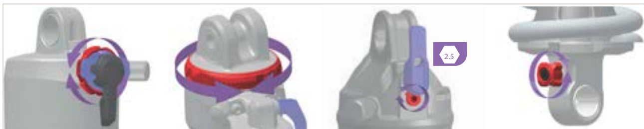
Figura 326: Ubicazione e forma del regolatore del rebound (rosso) in funzione del modello
