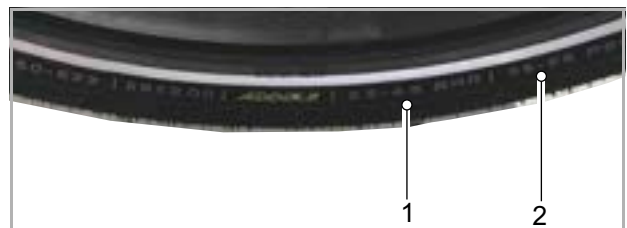
Figura 212: Pressione di gonfiaggio in bar (1) e in psi (2)
