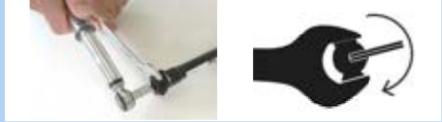
Figura 268: Regolazione in senso orario
