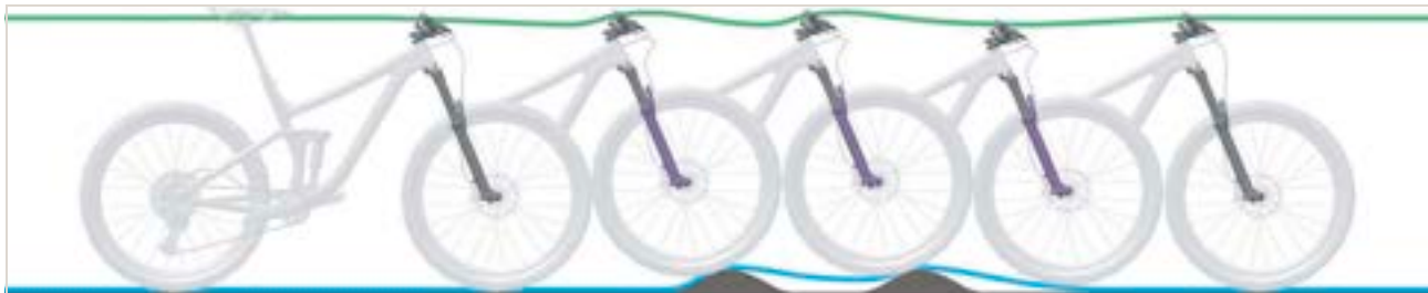
Figura 311: Corsa di estensione troppo lenta della forcella ammortizzata
