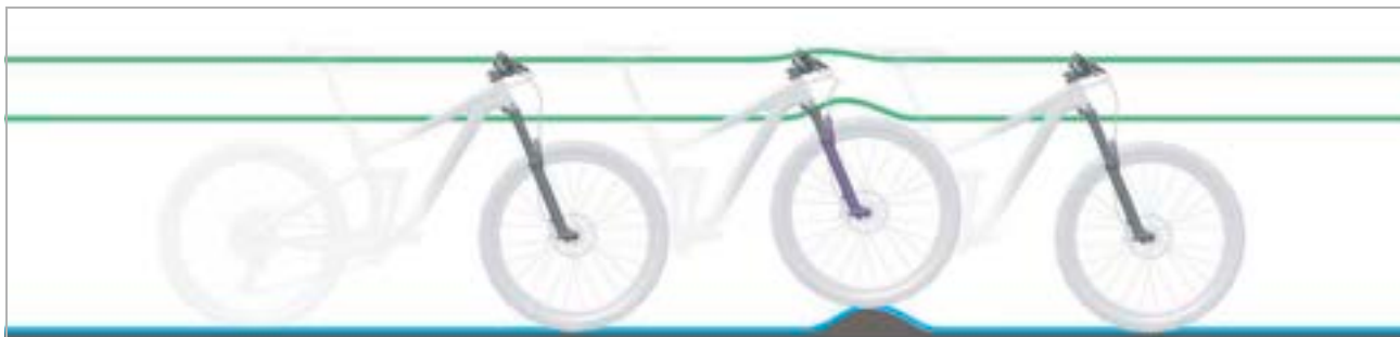
Figura 23: Comportamento di marcia ottimale della forcella ammortizzata su asperità
