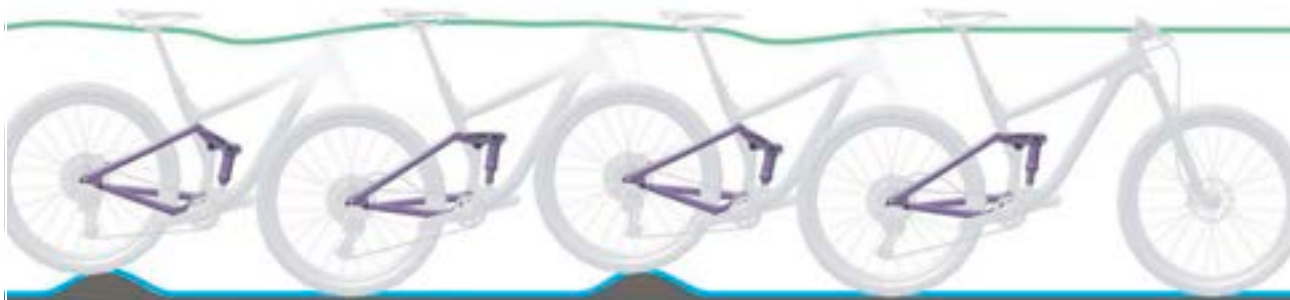
Figura 8: Comportamento di marcia ottimale dell'ammortizzatore del carro posteriore
