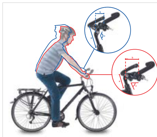
Figura 141: Posizione per bicicletta da città (blu) e per bicicletta da trekking (rosso) tramite modifica dell'angolo
