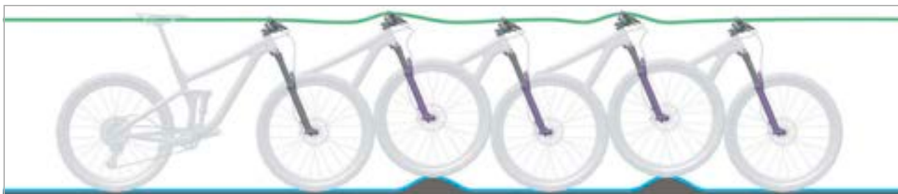
Figura 24: Comportamento di marcia ottimale della forcella ammortizzata
