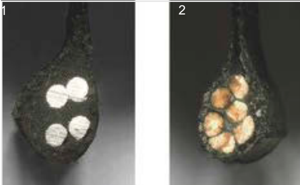
Figura 31: Cerchietto in acciaio (1) e cerchietto in Kevlar (2)
