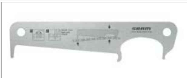
Figura 219: Esempio di calibro di misura dell'usura SRAM
