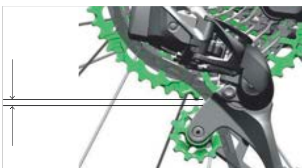
Figura 159: 3 mm di distanza tra puleggia di rinvio e denti
