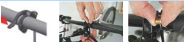
Figura 248: Smontaggio della cartuccia
