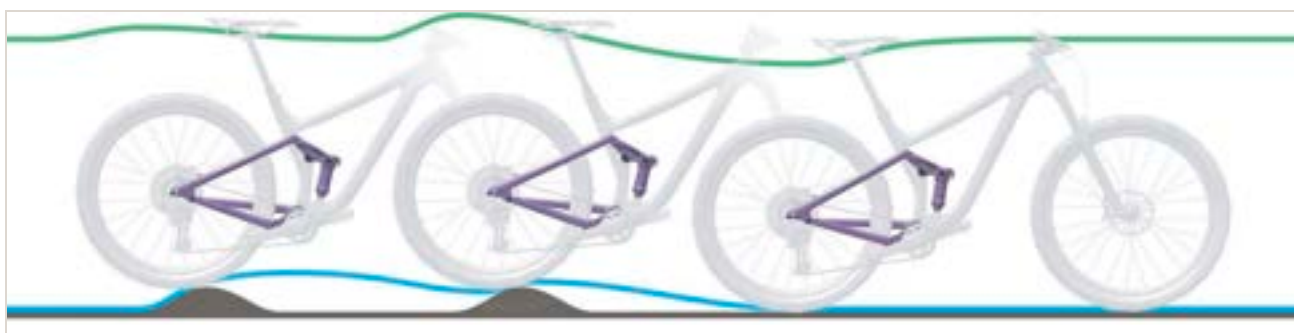
Figura 325: Corsa di estensione troppo lenta dell'ammortizzatore del carro posteriore
