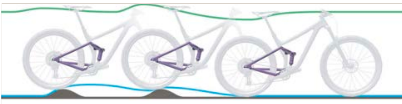
Figura 333: Corsa di estensione troppo lenta dell'ammortizzatore del carro posteriore
