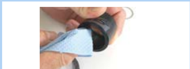
Figura 258: Pulizia della boccola esterna
