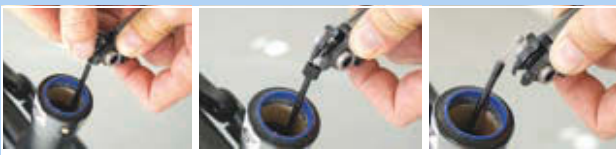
Figura 287: Rimozione del cavo meccanico
