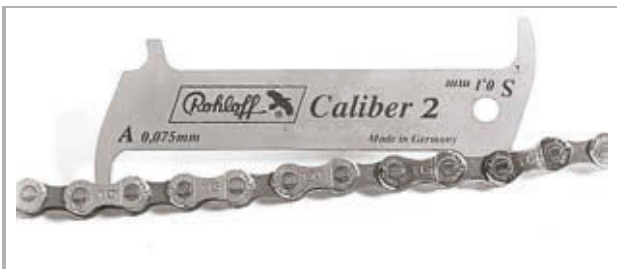
Figura 220: Esempio di calibro di misura dell'usura ROHLOFF
