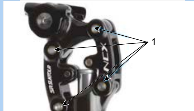
Figura 245: Punti di lubrificazione del canotto reggisella ammortizzato SR SUNTOUR
