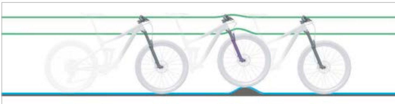
Figura 204: Ammortizzatore a stadi di pressione regolato su un comportamento rigido e morbido
