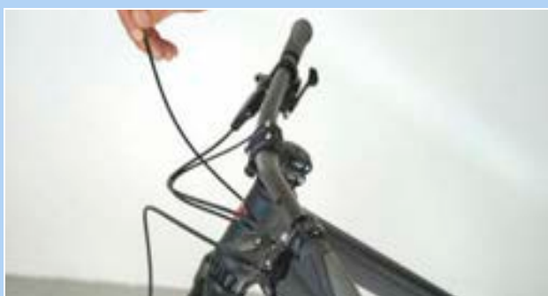
Figura 305: Aggancio del cappuccio terminale
