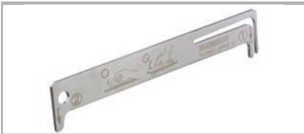
Figura 218: Esempio di calibro di misura dell'usura SHIMANO
