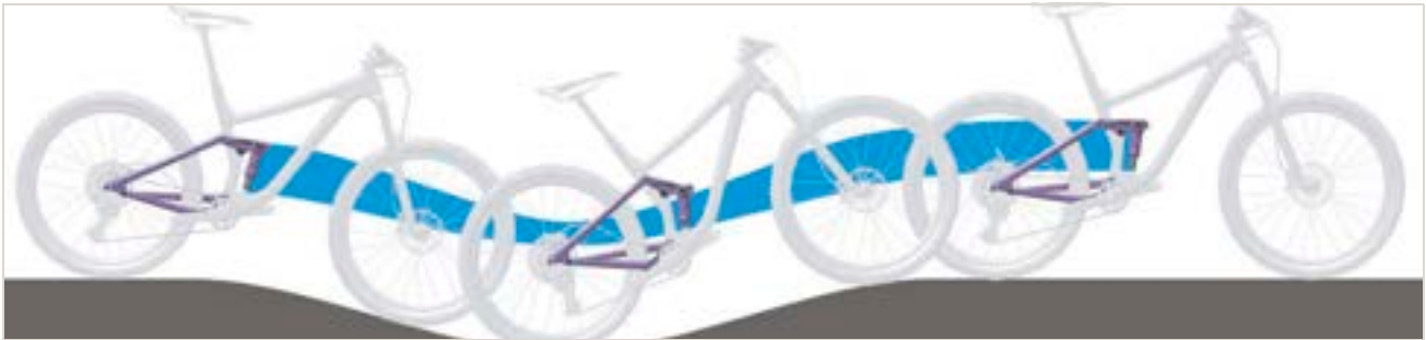
Figura 327: Sospensione dell'ammortizzatore del carro posteriore troppo morbida in salita
