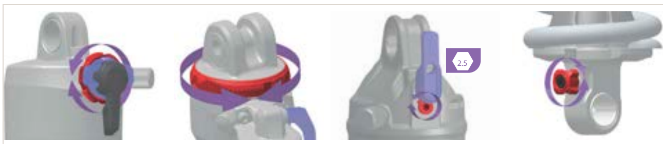
Figura 324: Ubicazione e forma del regolatore del rebound (ammortizzatore del carro posteriore) (rosso) in funzione del modello
