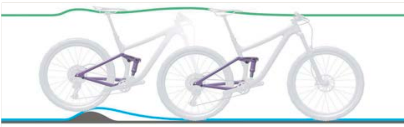
Figura 329: Smorzamento troppo rigido dell'ammortizzatore del carro posteriore su asperità
