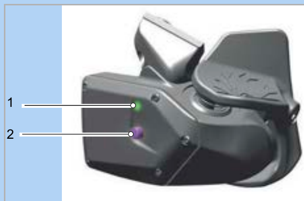
Figura 107: Deragliatore posteriore SRAM AXS Controller con indicatore a LED (deragliatore posteriore) (1) e tasto AXS (deragliatore posteriore) (2)
