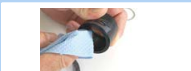
Figura 293: Pulizia della boccia esterna
