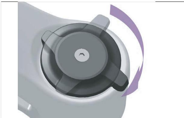
Illustration 482 : Régler le dispositif de réglage de la compression sur un niveau plus dur
