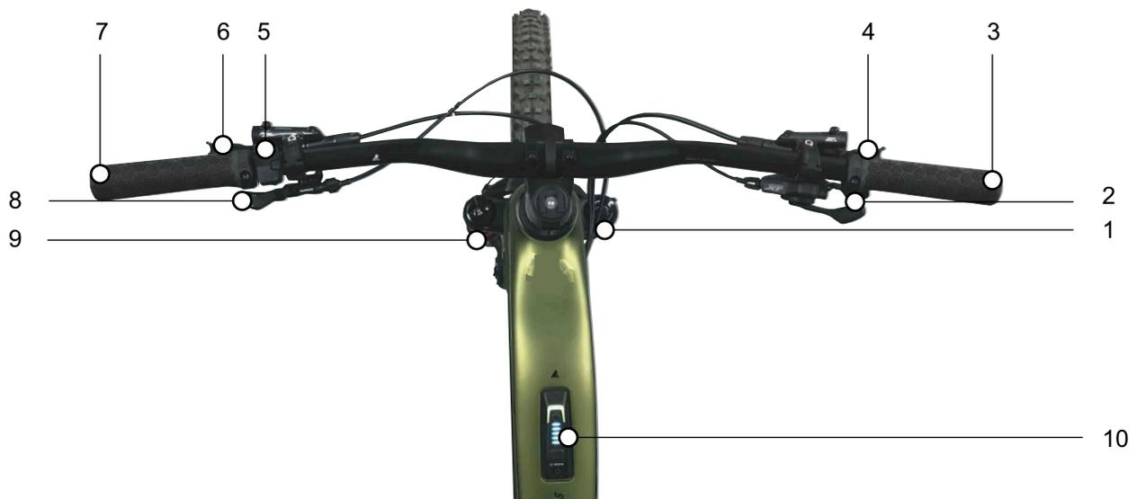
Illustration 121 : Vue détaillée du guidon avec ordinateur de bord BOSCH System Controller et unité de commande Mini Remote, exemple
