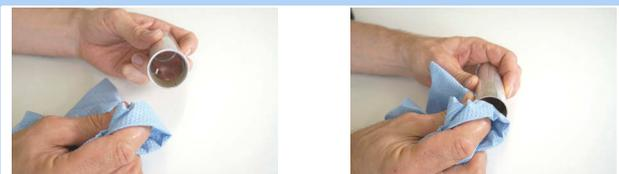
Illustration 416 : Nettoyer le tube de la douille de glissement
