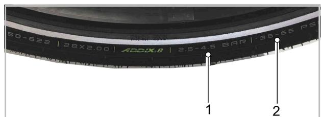
Illustration 366 : Indication de pression des pneus en bar (1) et psi (2)
