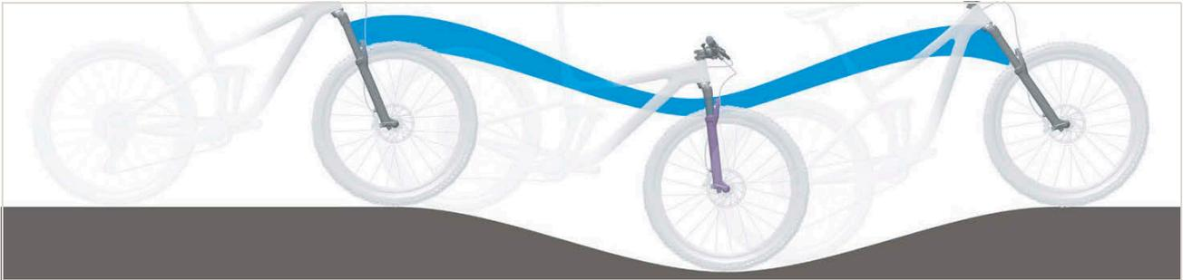
Illustration 489 : Suspension trop souple de la fourche suspendue dans les côtes
