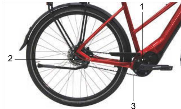
Illustration 74 : Schéma de l'entraînement à courroie
