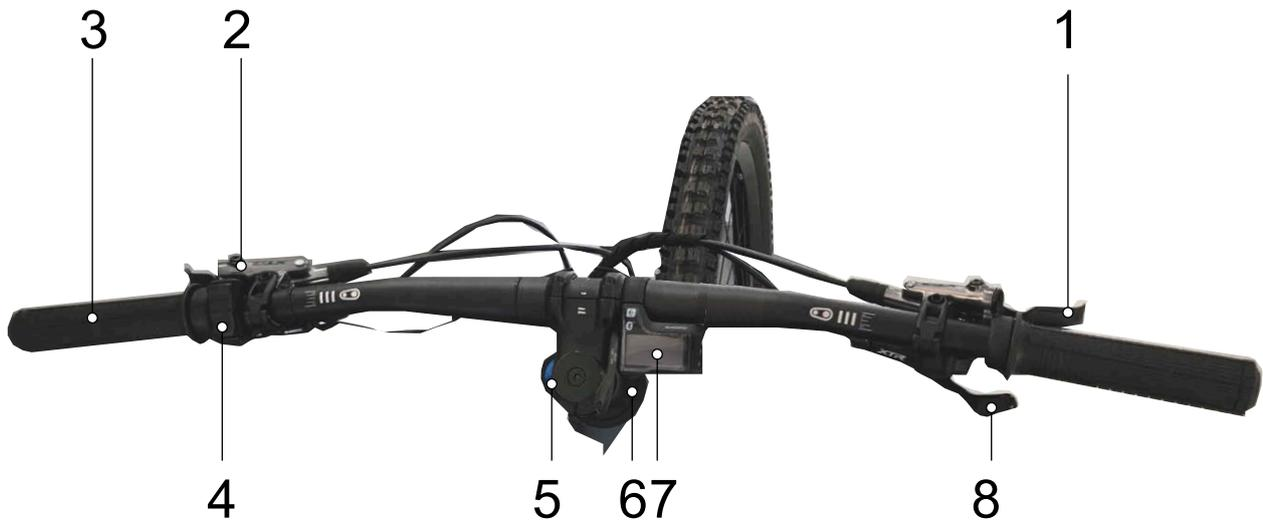
Illustration 151 : Vue détaillée d'un guidon avec ordinateur de bord SHIMANO SC-E800, exemple
