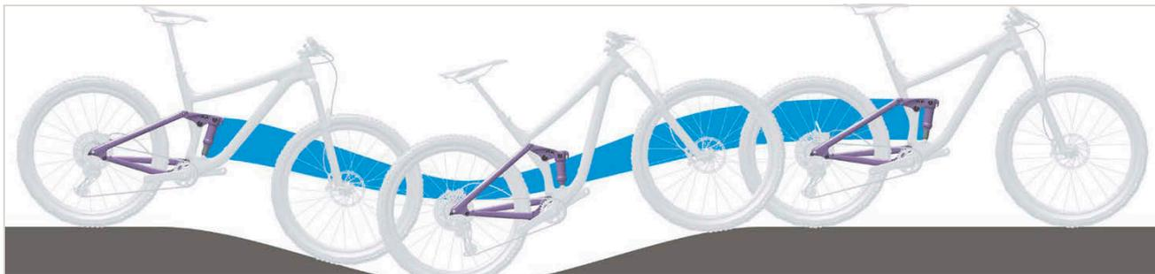
Illustration 515 : Suspension trop souple de l'amortisseur arrière dans les côtes
