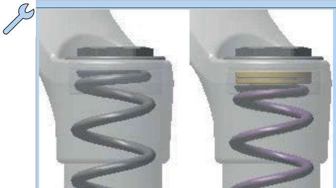
Illustration 243 : Serrer et desserrer l'anneau de réglage de la prétension
