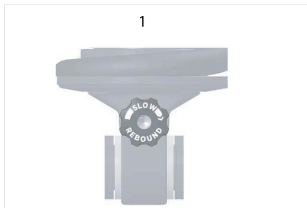
Illustration 257 : Dispositif de réglage de la détente du Float DHX (1)
