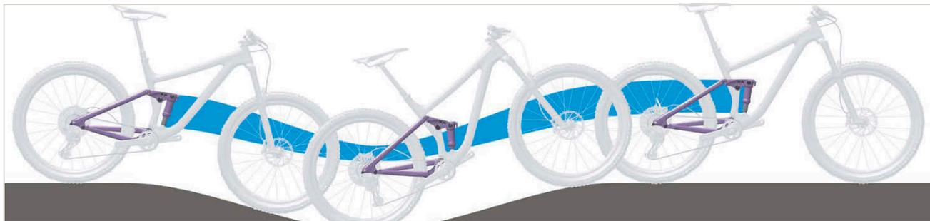
Illustration 507 : Suspension trop souple de l'amortisseur arrière dans les côtes
