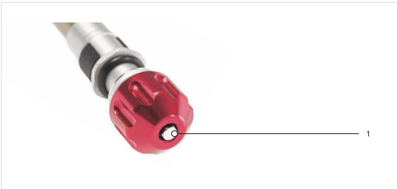
Illustration 251 : Exemple d'un réglage de détente SR SUNTOUR (fourche de suspension) (1)
