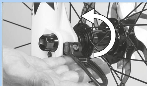
Illustration 179 : Enfoncez le levier d'attache rapide dans le sens de la flèche
