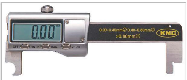
Illustration 376 : Exemple d'un gabarit de mesure numérique KMC
