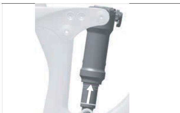
Illustration 248 : Déplacer le joint torique sur l'amortisseur arrière
