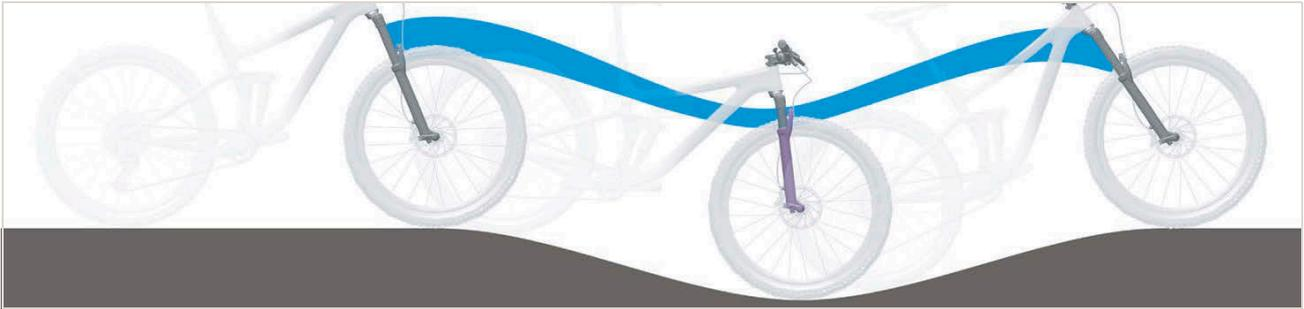
Illustration 481 : Suspension trop souple de la fourche suspendue dans les côtes
