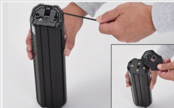
Afbeelding 35: Demontage bovenste interface
