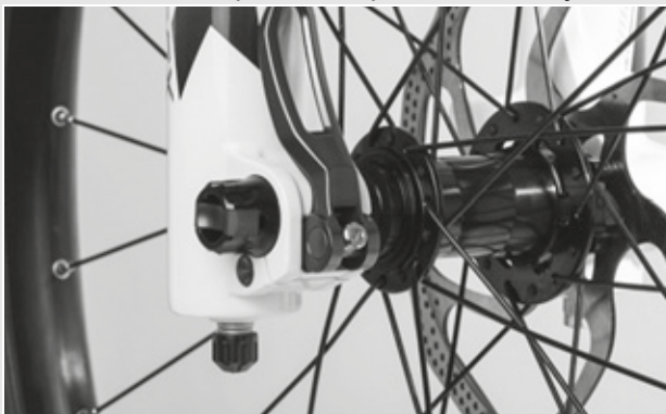
Afbeelding 49: Perfecte stand van de spanhendel
