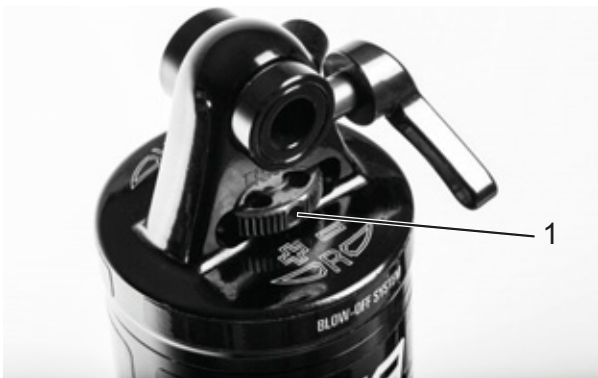
Afbeelding 74: Wiel (1) van de Suntour trekdemperafsteller op de achterbouwdemper
