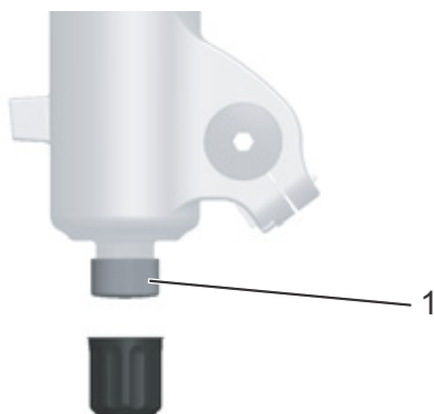
Afbeelding 73: FOX trekdemperafsteller (1) op het uitvaleinde van de vork
