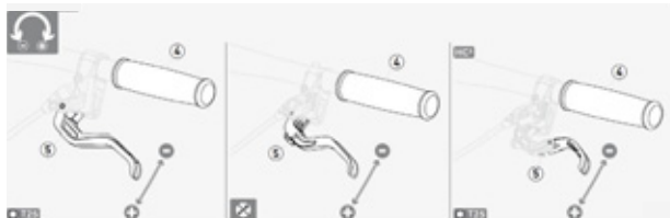
Afbeelding 68: Grijpafstand Magura schijfremhendel afstellen
