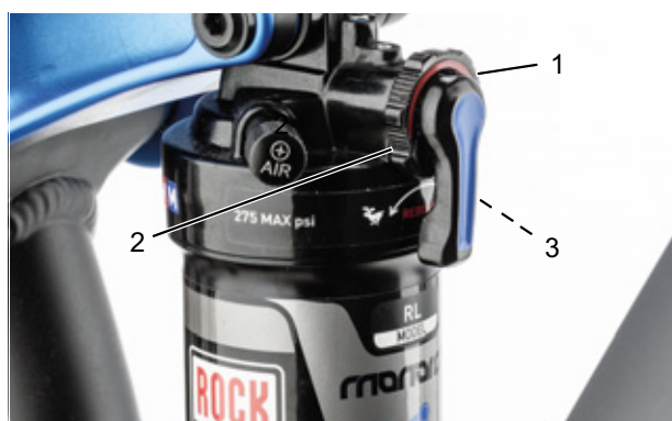
Afbeelding 88: Hardheid van de trekdemper afstellen met het afstelwiel (1) van de achterbouwdemper
