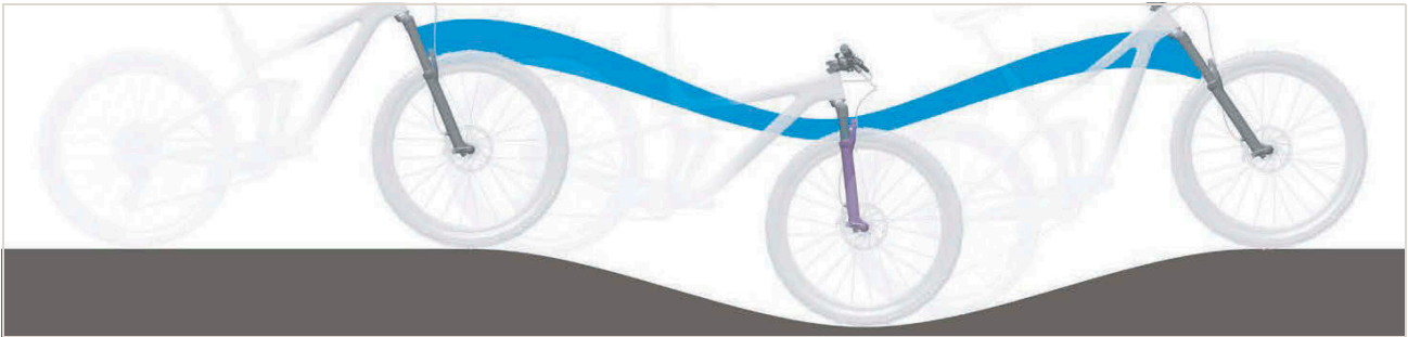
Slika 486: Premehko vzmetenje vzmetnih vilic na vzponih
