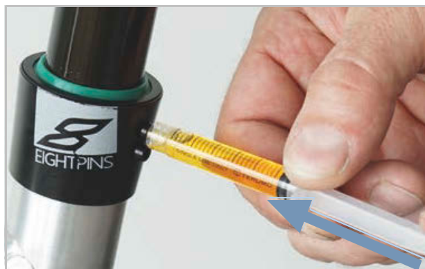
Slika 362: Mazanje sedežne opore EIGHTPINS
