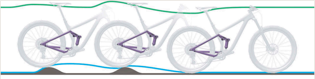
Slika 502: Prepočasni odboj zadnjega blažilnika
