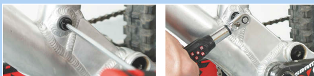
Slika 428: Pritrditev osi zatiča vretena
