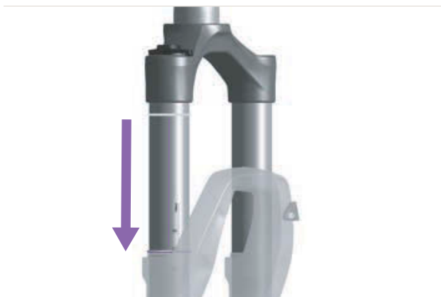
Slika 234: Premikanje tesnilnega obročka na vzmetnih vilicah
