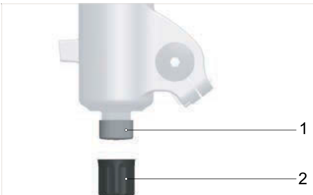
Slika 485: Regulator stopnje odboja FOX (vilice) (1) pod pokrovom vilic (2)
