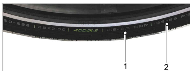
Slika 363: Informacije o polnilnem tlaku v barih (1) in psi (2)
