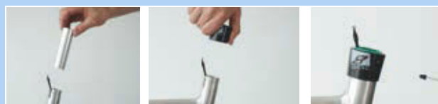
Slika 422: Vgradnja drsne puše in zunanjega tulca
