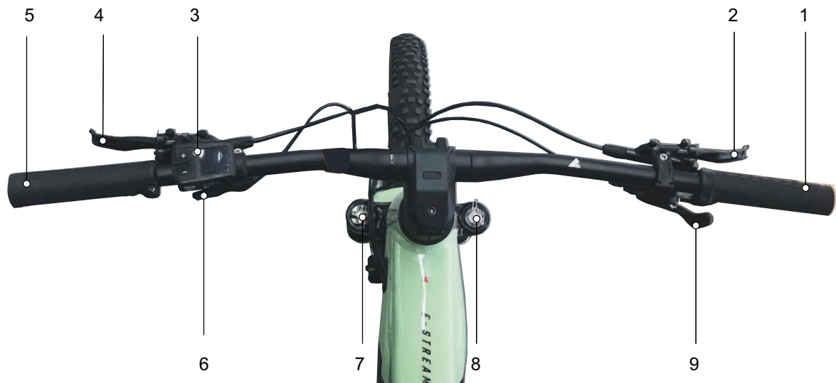
Slika 146: Podroben prikaz krmila s FIT LED Remote, primer
