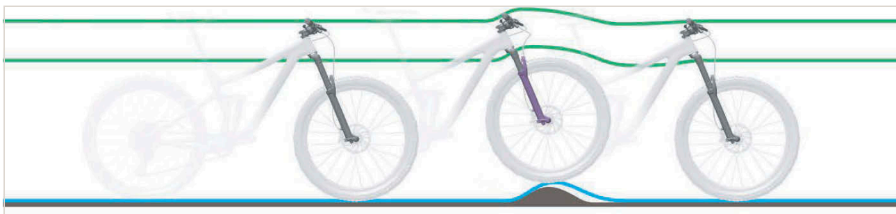
Slika 489: Pretrdo blaženje vzmetnih vilic na neravnih površinah
