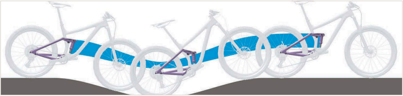
Slika 512: Premehko vzmetenje zadnjega blažilnika na vzponih
