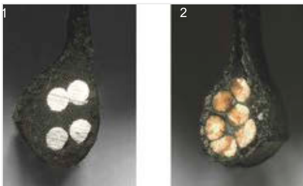
Slika 44: Jekleno jedro (1) in jedro iz kevlarja (2)
