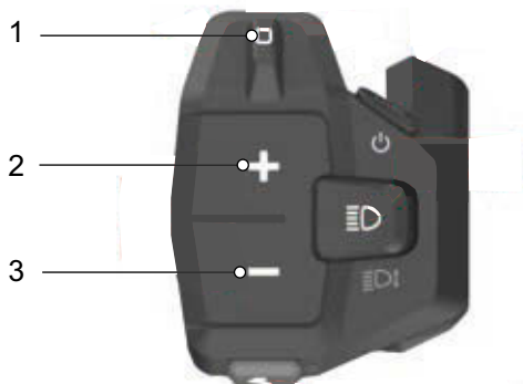
Slika 275: Položaj navigacijske ročice (1), tipk plus (2) in minus (3) |
