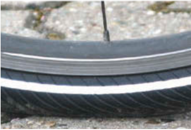
Slika 216: Pravilen polnilni tlak. Pnevmatika se pri obremenitvi s telesno težo skoraj ne deformira
