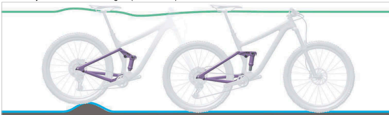
Slika 316: Optimalno vozno obnašanje zadnjega blažilnika na neravninah
