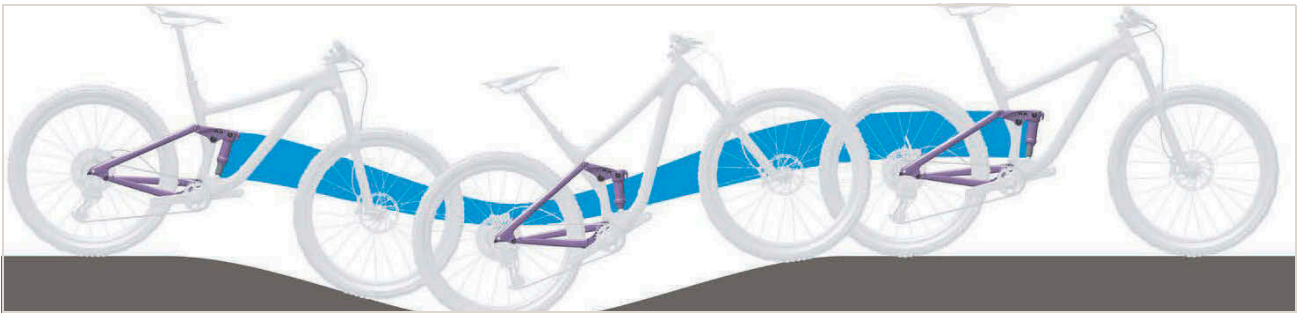
Slika 496: Premehko vzmetenje zadnjega blažilnika na vzponih
