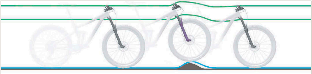
Slika 480: Pretrdo blaženje vzmetnih vilic na neravnih površinah
