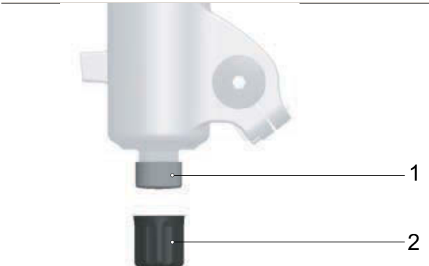
Slika 483: Regulator stopnje odboja FOX (vilice) (1) pod pokrovom vilic (2)
