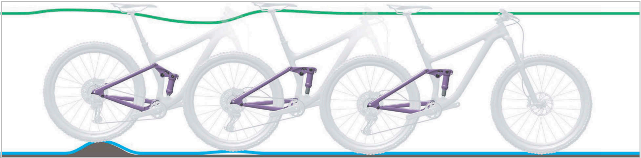
Slika 492: Prehitri odboj zadnjega blažilnika
