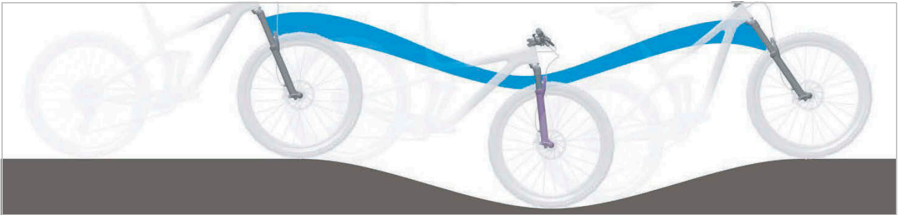
Slika 472: Premehko vzmetenje vzmetnih vilic na vzponih
