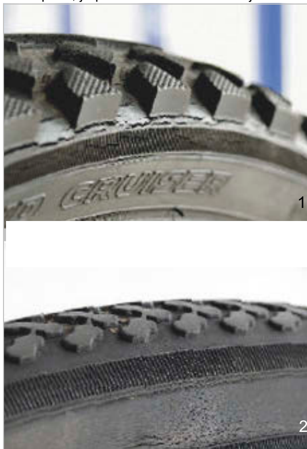
Slika 365: Primeri razpok zaradi utrujenosti (1) in razpok zaradi staranja (2)
