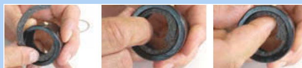
Slika 411: Vstavljanje klobučevinastega obroča
