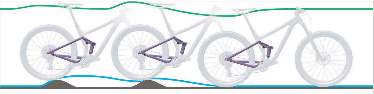
Slika 494: Prepočasni odboj zadnjega blažilnika
