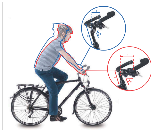
Slika 214: Položaj mestnega kolesa (modra) in treking kolesa (rdeča) s spreminjanjem kota
