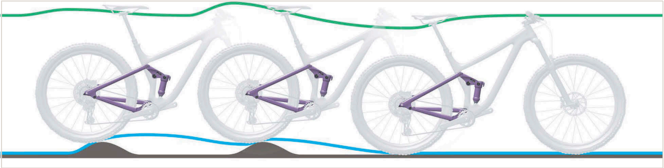
Slika 510: Prepočasni odboj zadnjega blažilnika
