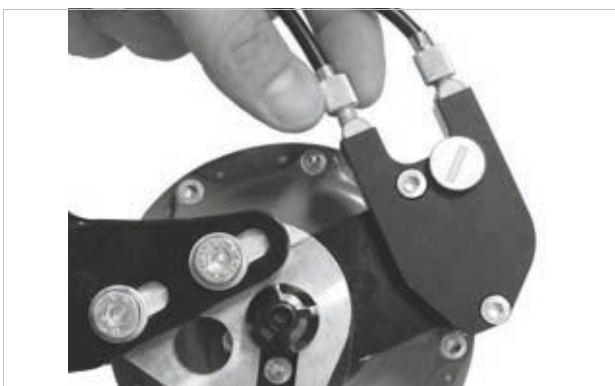
Slika 392: Različice pesta ROHLOFF z zunanjim krmiljenjem prestavljanja imajo regulatorje vleka na škatli za kable, ki se nahaja na levi strani
