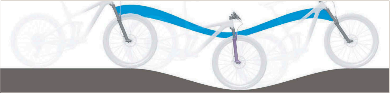
Slika 478: Premehko vzmetenje vzmetnih vilic na vzponih
