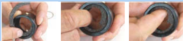
Slika 446: Vstavljanje klobučevinastega obroča
