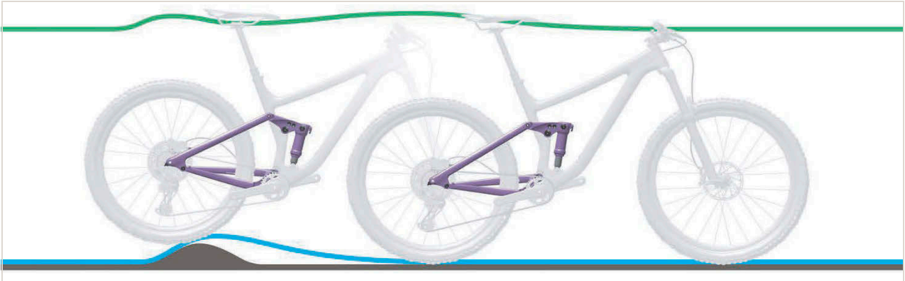
Slika 514: Pretrdo blaženje zadnjega blažilnika na neravnih površinah
