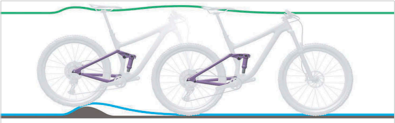
Slika 498: Pretrdo blaženje zadnjega blažilnika na neravnih površinah
