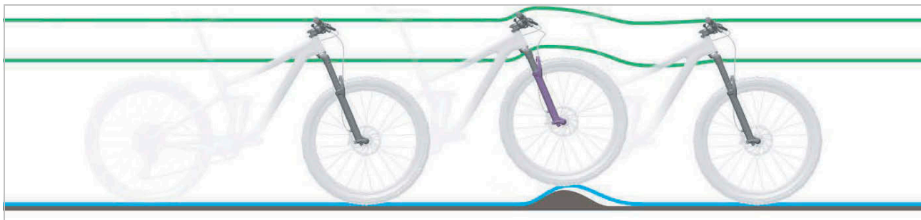
Slika 473: Pretrdo blaženje vzmetnih vilic na neravnih površinah
