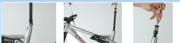
Slika 426: Pritrditev pokrova ventila kartuše
